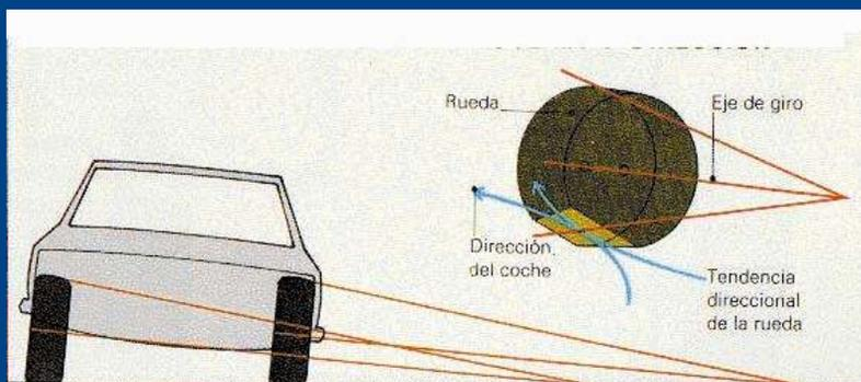
En algunas suspensiones independientes, la inclinación de la carrocería en curvas demasiado cerradas afecta también a la inclinación de los neumáticos. Entonces, las ruedas tienden a rodar en círculos cada uno con centro en el punto donde la prolongación del eje corta el piso, al igual que un cono tumbado giraría alrededor de su vértice. Esto produce un infravirado.
