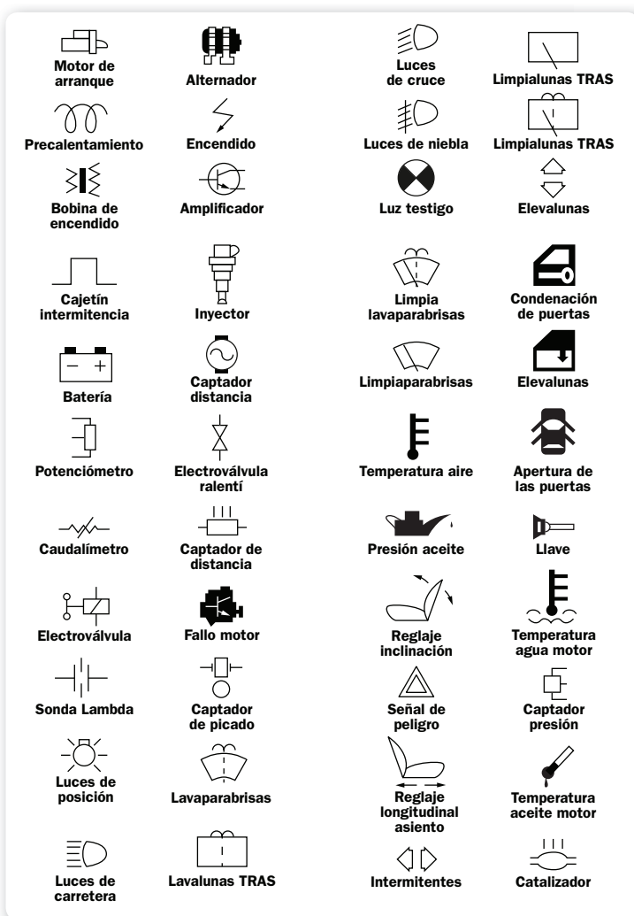
Figura 3. Esta simbología representa los distintos módulos eléctricos y electrónicos del vehículo, como por ejemplo las luces, la temperatura del motor y la presión de aceite. Es exclusiva de la industria automotriz.
