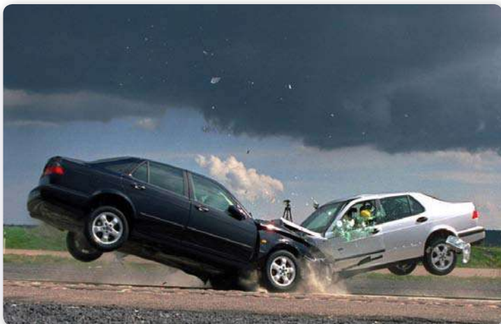
Figura 16. Prueba de colisión entre dos vehículos a una velocidad de 65 km/h.
