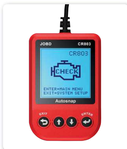
Figura 3. Lector de códigos de error para el sistema JOBID.
