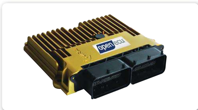
Figura 11. Computadora automotriz o unidad central electrónica. Se caracteriza por su carcasa metálica, que sirve para disipar el calor de los componentes internos.
