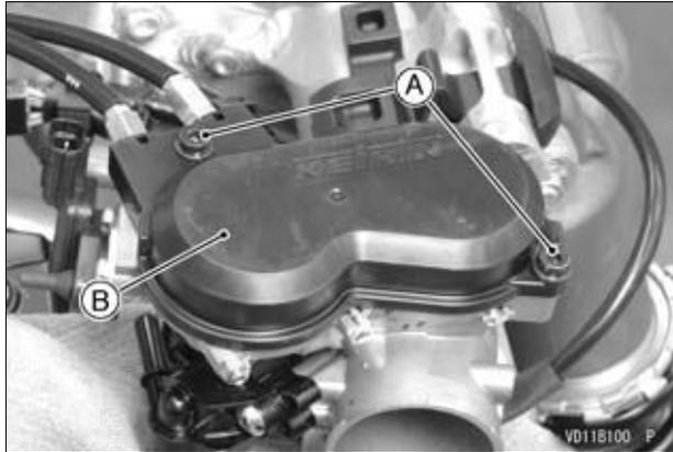
A. Pernos de la cubierta de la polea del acelerador
