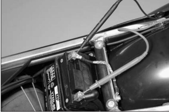
**Salida del regulador** – medir el valor de la tensión con las puntas de medición del adaptador de tensión de punta 584.29.042.000 directamente en los polos de la batería del vehículo:
