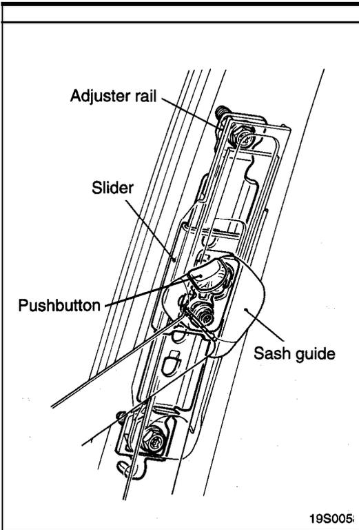
**ONE-TOUCH PUSHBUTTON TYPE ADJUSTABLE SHOULDER BELT ANCHOR**
