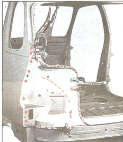
Colocar las piezas nuevas y fijarlas con pinzas para proceder a su soldadura.
