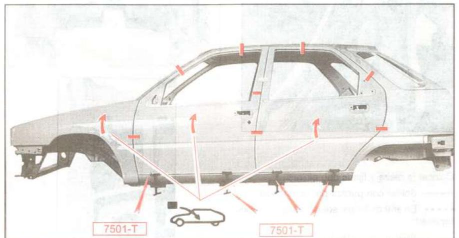
Colocar sobre la carrocería los útiles 7501-t. Colocar las puertas en su sitio controlando el juego del contorno de puertas.
