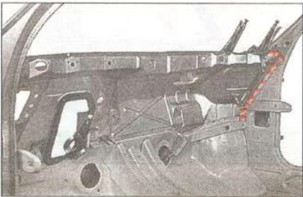
Soldar en ambos lados con puntos por resistencia, lijar con disco flexible y proceder al cincado de las piezas.
