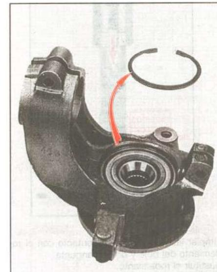
Extraer la mangueta y retirar el circlip de retención del rodamiento.
