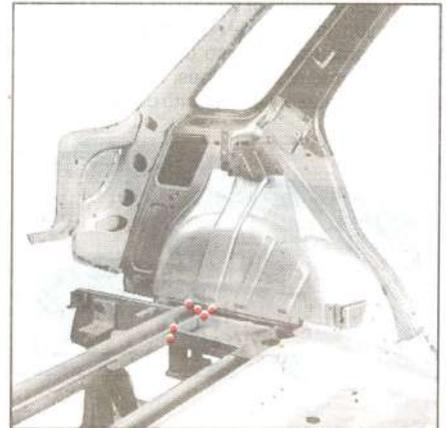
Colocar el larguero trasero y efectuar su soldadura con puntos por resistencia en ambos lados.
