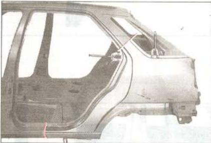
Sobre la carrocería, colocar la pieza nueva y marcar para el ajuste por recubrimiento, retirar la pieza nueva.
