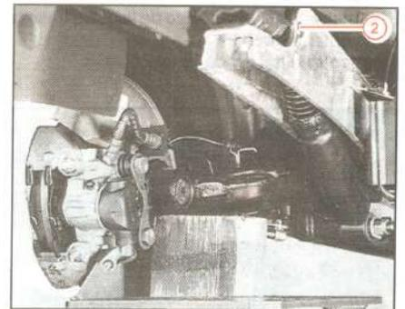
Colocar un gato bajo el brazo de suspensión y desmontar el tornillo (2) del amortiguador.
