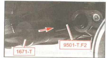
Montar los útiles 1671-T.F2. Desacoplar la barra estabilizadora y la palanca (4) con el extractor de inercia 1671-T.
