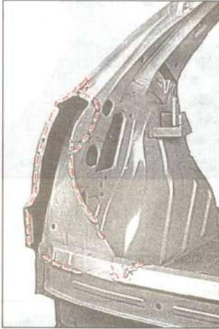
Aplanar, lijar con disco flexible y aplicar una capa de imprimación conductora sobre las zonas de unión de la carrocería.
