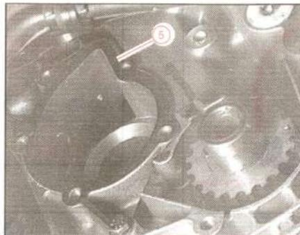
Montar una junta (5) nueva y la bomba de agua. Apretar los cinco tornillos (4). (Apretete: 1,5 daN.m).
