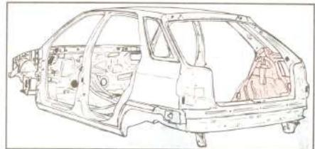
Retirar la batería, la luna de custodia, asiento trasero, cinturón, paragolpes, piloto, guarnecidos y si es necesario, el depósito de combustible y el tren trasero.
