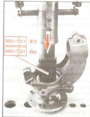
Colocar el circlip de retención del rodamiento e introducir el buje en la mangueta con ayuda de una prensa y del útil 9501-T, C1 (TU) 9501-T, D1 (XU).
