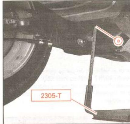
Las alturas traseras se miden entre el suelo y la traviesa tubular en los puntos (a) (φ 58 mm). Las alturas delanteras se miden entre el suelo y el eje de articulación delantero del brazo.
