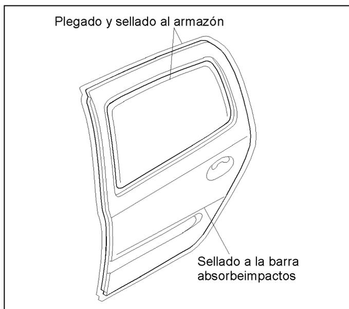
Figura 40.- Unión del panel de la puerta trasera
