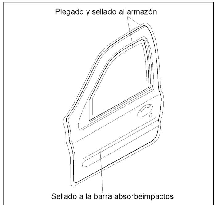
**Figura 37.-** Unión del panel de la puerta delantera
