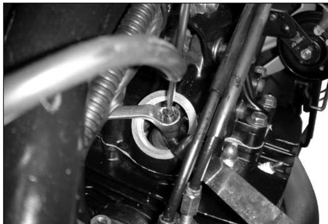
Fixe o parafuso de ajuste e aperte a contraporca com o torque especificado.
