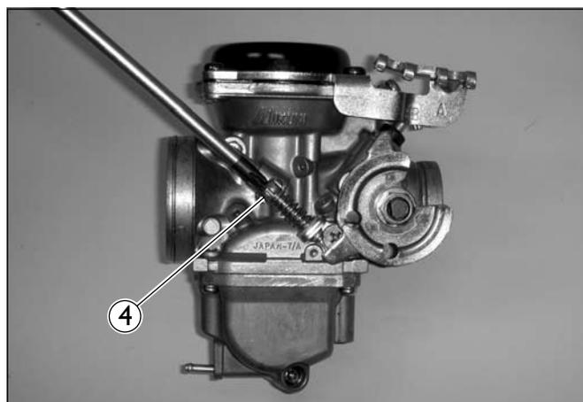
Retire a arruela de calço ⑤ e a mola ⑥ do parafuso de aceleração ④.
