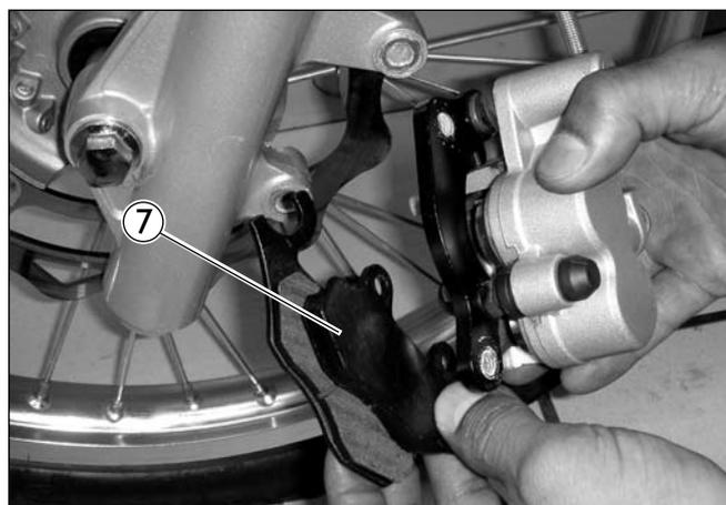
Inspecione as pastilhas de freio quanto a desgaste excessivo, irregular e/ou incrustao de impurezas. Substitua caso necessrio.
