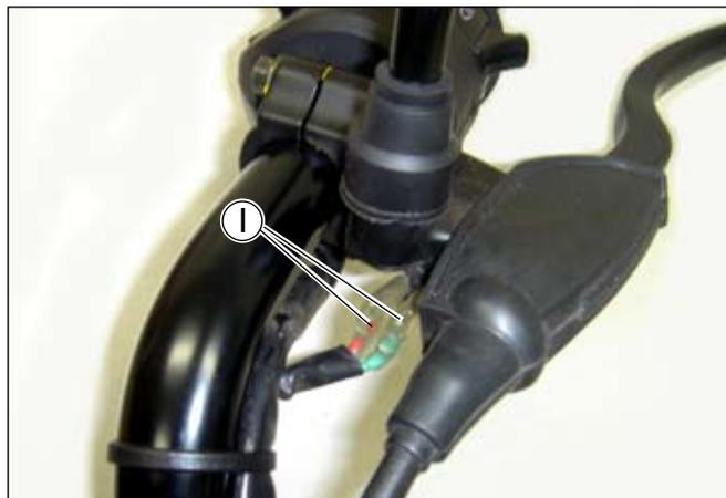
Conecte o multímetro nos terminais do interruptor e faça o teste de continuidade.
