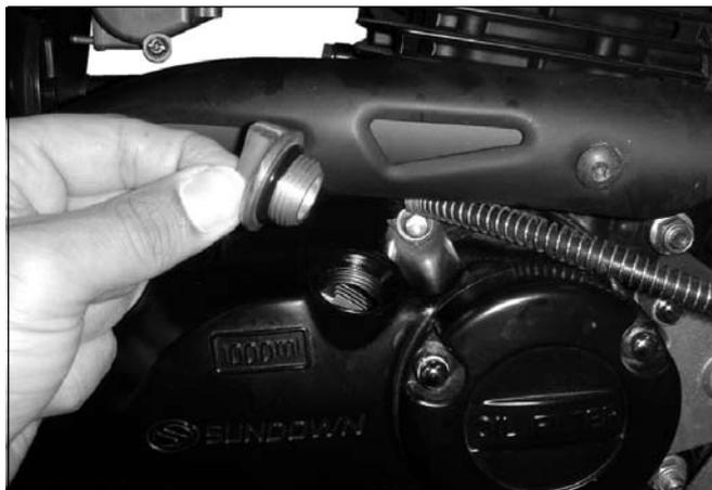
Inspeção as condições do anel de vedação da tampa de abastecimento de óleo. Substitua-o se necessário.
