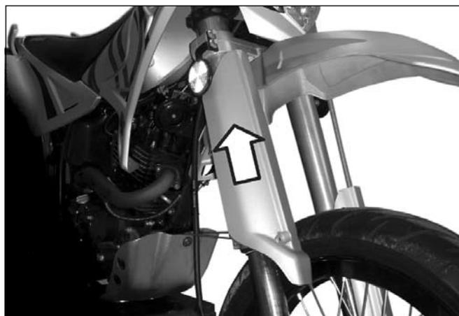
Remova os parafusos e desloque o protetor do garfo ❸ esquerdo para cima até desencaixar da guia.
