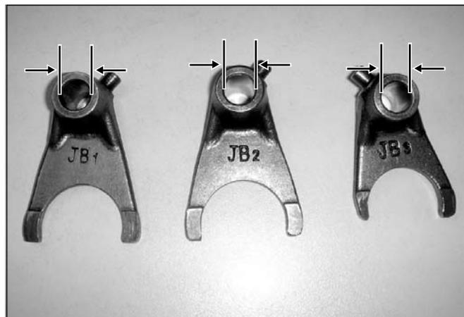
Meça a espessura dos dentes dos garfos seletores.
