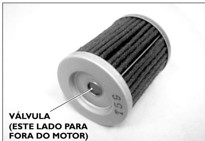
Instale um novo anel de vedação **26** no interior do alojamento do filtro e o elemento do filtro de óleo **27**.
