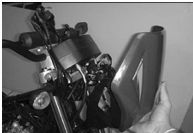
Desacople os conectores ❷ e ❸ da fiação do farol e lanterna.
