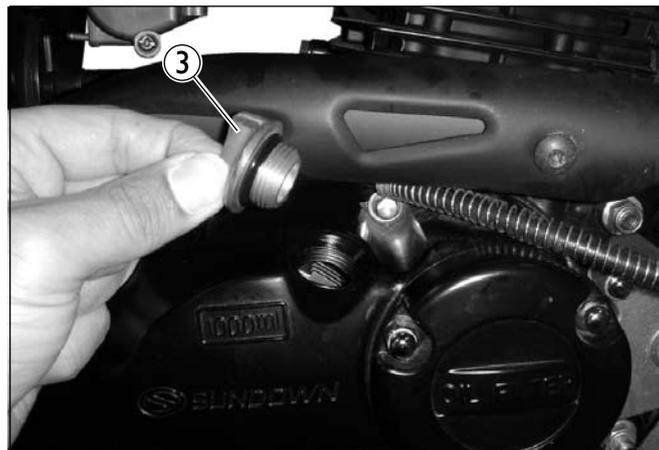
Inspecione a arruela de vedação ④ do parafuso de dreno ⑤ e, se necessário, substitua-a.
