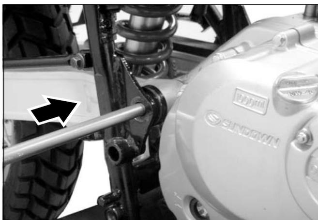
Desloque o eixo da balança traseira 51 para o lado esquerdo da motocicleta, mas não remova-o.
