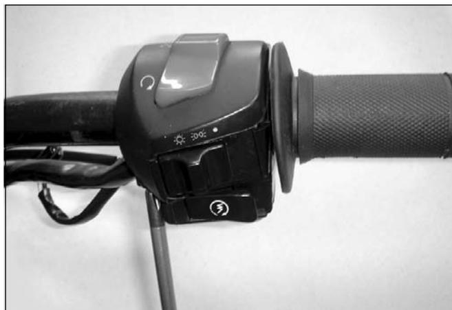
Desacople os cabos da manopla do acelerador. Remova o conjunto de interruptores/carcaça do acelerador.
