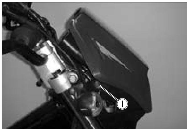
Remova o parafuso direito, desloque a carenagem para cima e para frente soltando os encaixes inferiores da carenagem do farol.
