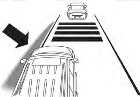
Aproximación de carril (línea gruesa destellando amarillo, la línea delgada es de color amarillo sólido/indicador 0310100714US destellando de color amarillo)
