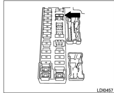
Si se usa un fusible tipo A para reemplazar a uno tipo B, el fusible tipo A no queda al nivel del contenedor de fusibles, tal como aparece en la ilustración. Esto no afecta al desempeño del fusible. Asegúrese de que el fusible quede firmemente instalado en la caja de fusibles.
