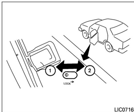
Quando la palanca está en la posición "LOCK" ②, la puerta se puede abrir sólo desde el exterior.
