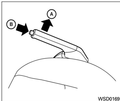
**Para aplicarlo:** Jale la palanca del freno de estacionamiento hacia arriba (A).
