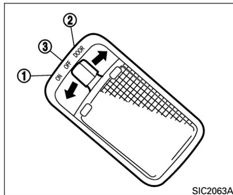
La luz interior tiene un interruptor de tres posiciones y funciona independientemente de la posición del interruptor de encendido.
