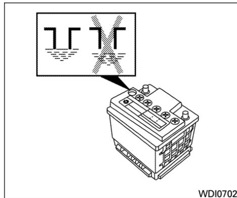
2. Revise el nivel del líquido en cada celda. Si fuera necesario agregar líquido, use sólo agua destilada para hacer subir el nivel a la parte inferior de la abertura de llenado. **No llene en exceso.** Reinstale las tapas de ventilación.
