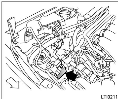
**ETIQUETA DE IDENTIFICACIÓN DEL VEHÍCULO CON COMBUSTIBLE FLEXIBLE (sólo si está equipado)**
