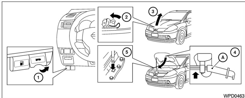
1. Jale la palanca de liberación de seguro del cofre ① ubicada debajo del tablero de instrumentos hasta que el cofre se abra levemente.
