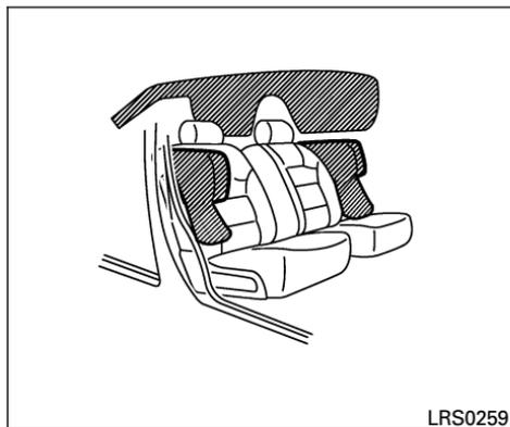
Bolsa de aire complementaria para impactos laterales instalada en el asiento delantero (sólo si está equipado) y bolsa de aire complementaria para impactos laterales, tipo cortina, instalada en el techo (sólo si está equipado)
