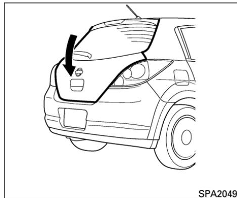
Para cerrar la compuerta trasera, empujela hacia abajo hasta que quede asegurada.
