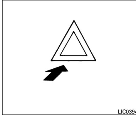
Oprima el interruptor para encenderlo y así advertir a otros conductores cuando debe detenerse o estacionarse en condiciones de emergencia. Todas las luces direccionales destellan.
