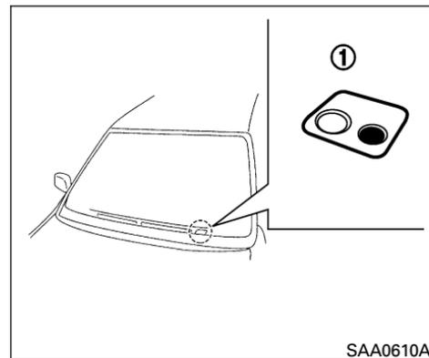
El sensor de carga solar ①, ubicado en la parte central superior del tablero de instrumentos, ayuda a que el sistema mantenga una temperatura constante. No coloque nada sobre o en los alrededores de este sensor.
