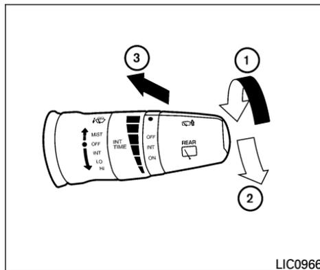
El limpiador y el lavador del cristal trasero funcionan al poner el interruptor de encendido en la posición de "ON" (Encendido).
