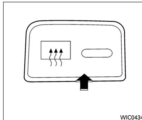
Para desempañar el cristal trasero, ponga en marcha el motor y active el interruptor correspondiente. Se enciende la luz indicadora del desempañador del cristal trasero en el interruptor. Oprima nuevamente el interruptor para desactivar el desempañador.
