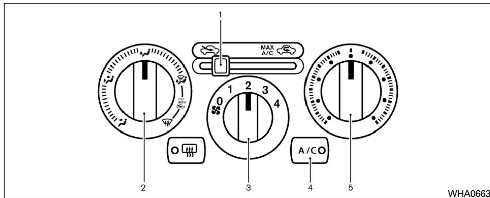
1. Palanca de admisión de aire (circulación de aire exterior/recirculación del aire)
