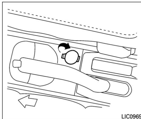
El tomacorriente tiene como objetivo proporcionar energía a los accesorios eléctricos, como teléfonos celulares. La capacidad máxima nominal del tomacorriente es de 12 voltios, 120 W (10A).
