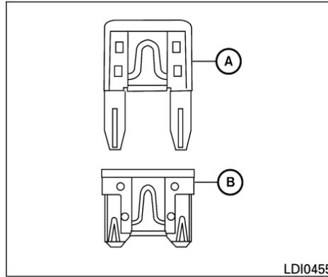
Se usan dos tipos de fusibles. El tipo A se usa en las cajas de fusibles del compartimento del motor. El tipo B se usa en la caja de fusibles del compartimento de pasajeros.
