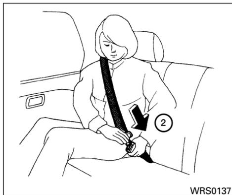
② Jale lentamente el cinturón de seguridad para sacarlo del retractor e inserte la lengüeta en la hebilla hasta que escuche y sienta que el seguro se engancha.
