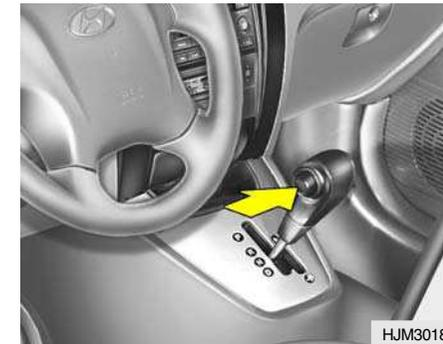
La transmisión automática de alta eficacia Hyundai, tiene cuatro / cinco velocidades hacia adelante y una velocidad hacia atrás. Las velocidades individuales se seleccionan automáticamente, dependiendo de la posición de la palanca del selector de velocidad. La palanca del selector tiene 2 secciones: la sección principal y la sección manual.
