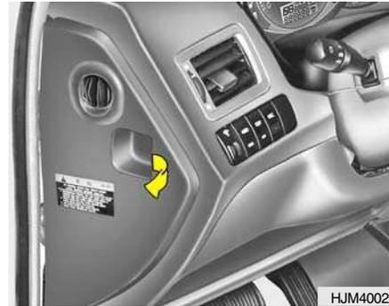
La caja de fusibles correspondiente a las luces y otros dispositivos eléctricos se encuentra en el lado izquierdo del cojín de colisión. En el interior de la caja se encuentra una lista de los circuitos protegidos por cada fusible.
