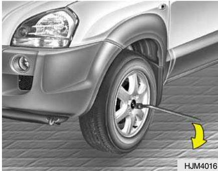
Haga descender el vehículo hasta el suelo girando la llave de tuercas en sentido antihorario. Después ponga la llave como se indica en el figura y apriete los espárragos de la rueda, asegúrese que la llave cubra completamente el perno. No se ponga de pie sobre la herramienta ni use un tubo de extensión en la herramienta. Vaya alrededor de la rueda apretando cada uno de los espárragos hasta que queden todos apretados.
