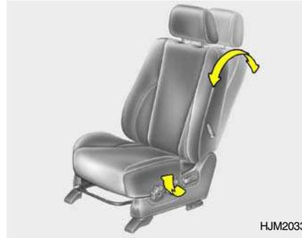
Para poder ajustar la inclinación del respaldo, usted debe inclinar su cuerpo ligeramente, de manera que el peso de la espalda no este contra el respaldo, en ese momento usted levanta la manilla que esta en la esquina del asiento, con la otra mano mueve el respaldo al ángulo deseado, luego para fijarlo, no tiene más que soltar la manilla.
