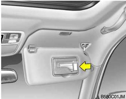
En la parte trasera de la visera se encuentra un pequeño portatarjeta para sujetar la tarjeta de peaje.
