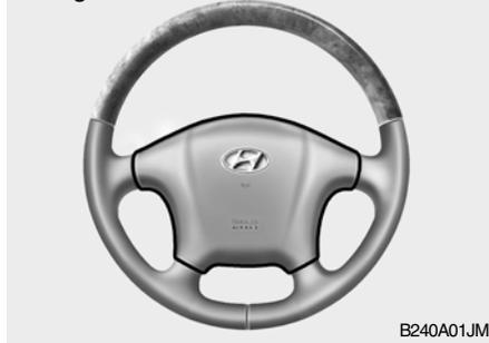
Su Hyundai está equipado con un AIRBAG. Los indicadores de presencia del sistema están marcados con las letras SRS Air bag en la tapa del volante y en el salpicadero en el lado del acompañante.
