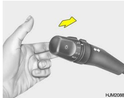
Si se acciona la palanca del mando selector de luces hacia arriba y luego se suelta, obtendrá un destello de las luces largas.
