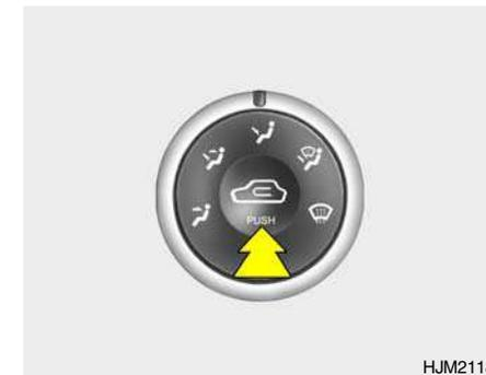
Este dispositivo es utilizado para elegir aire fresco del exterior o recirculación de aire del interior. Para cambiar la selección de admisión de aire, (aire fresco o recirculación) pulse el botón de control.
