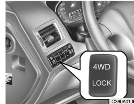
El sistema 4WD se ha diseñado para dividir automáticamente la potencia en condiciones normales de conducción.
