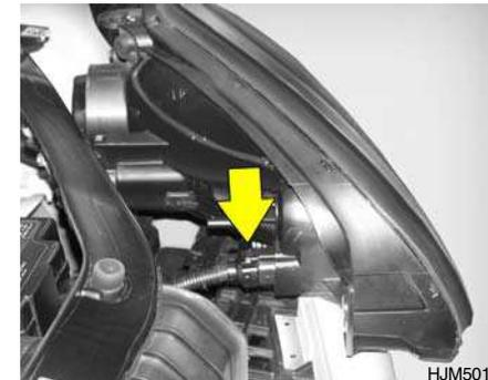
5. Desconecte el cable de conexión de la base de la bombilla en la parte trasera del faro.
