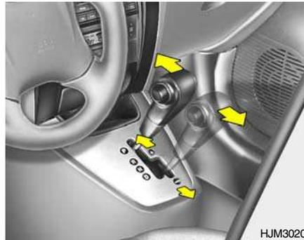
Tanto si el vehículo está detenido como si está en movimiento, el modo deportivo se selecciona empujando la palanca selectora desde la posición "D" a la sección manual.
