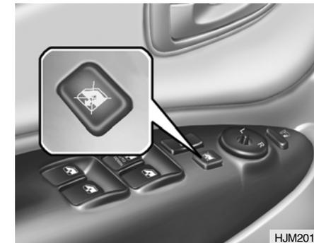
Para prevenir la apertura de las ventanas traseras por los pasajeros, se dispone de un interruptor en el reposabrazos del conductor. Para desactivar los interruptores traseros de las puertas, presionar el interruptor de bloqueo. Para volver al funcionamiento normal, presionar de nuevo el interruptor de bloqueo.
