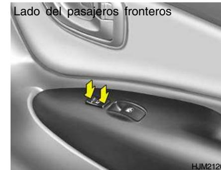
El interruptor del cierre centralizado de puertas está instalado sobre el reposabrazos lateral del conductor.
