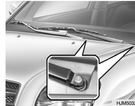
Las plumillas limpiaparabrisas deben ser inspeccionadas de vez en cuando y limpiadas para sacar la pelícutecula de polvo y suciedad acumulada. Para limpiarlas debe emplear una esponja con agua limpia y jabón. Si las plumillas dejan surcos o manchas en los parabrisas, reemplácelas por piezas originales HYUNDAI.
