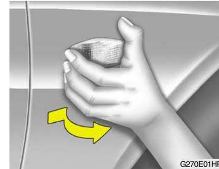
1. Empuje la cubierta hacia la parte frontal del vehículo y extráigalo.
