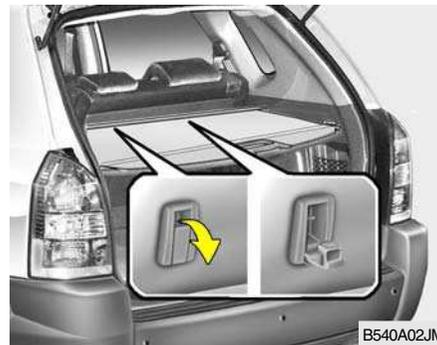
Los ganchos para bolsas se encuentran en la consola delantera y en la parte trasera del respaldo del asiento trasero. Si no se usa, regréselo a su posición original.
