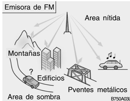
Las ondas de FM son de alta frecuencia y no pueden curvarse para seguir la curvatura de la tierra. Como consecuencia de esto las ondas de FM se comienzan a perder a corta distancia de la emisora. Además este tipo de señal es fácilmente afectada por los edificios, cerros u otros tipos de obstáculos. Esto ocasiona que usted crea que existe algún tipo de problema con su equipo de radio. Las siguientes condiciones son normales y no indican problema de su radio:
