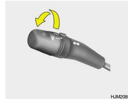
Para accionar el alumbrado automático, gire el extremo del cuerpo del selector multifunción. Si coloca el selector multifunción en "AUTO", los pilotos traseros y los faros se encenderán o bien se apagarán automáticamente según la iluminación exterior.
