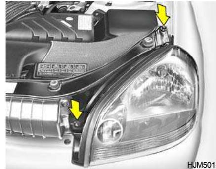
4. Con una llave inglesa extraiga los pernos de montaje del faro.
