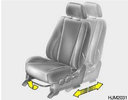
Para mover el asiento atrás o adelante, tire del seguro hacia arriba. Esto soltará el asiento y le permitirá desplazarlo hacia atrás o adelante según desee. Cuando encuentre la posición deseada, suelte la palanca y desplace el asiento suavemente hasta que se asegure y no se mueva más.
