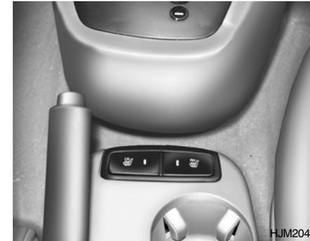
El calentador del asiento proporciona calor al asiento delantero durante tiempo frío. Con la llave de contacto en la posición "ON", presione los interruptores ubicados en la parte delantera de la consola para calentar el asiento del conductor o el del acompañante.
