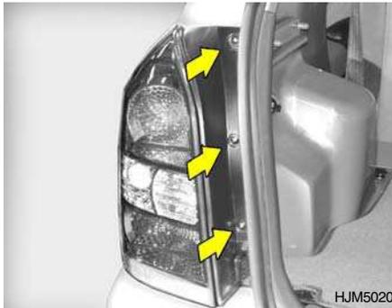
1. Abra la cubierta de las luces traseras.
