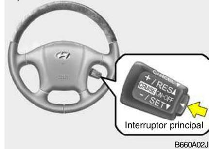
Este dispositivo controla de la velocidad del vehículo para su comodidad, cuando conduzca en autopistas. Este sistema está diseñado para funcionar a velocidades por encima de 15 millas o 40 kilómetros por hora.
