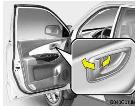
Las puertas pueden ser cerradas sin necesidad de utilizar la llave. Para cerrarlas desde el exterior, presionar primero el interruptor interior de cierre a la posición "LOCK" de manera que la marca roja del interruptor quede oculta y después cerrar la puerta.
