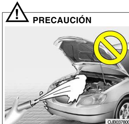
**o La entrada de agua al limpiar el compartimento del motor o la alta presión del agua durante el lavado puede provocar un fallo del circuito eléctrico ubicado en el compartimento del motor.**
