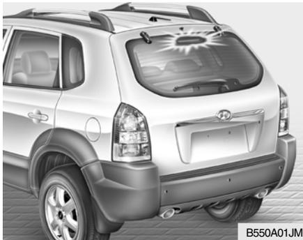
En complemento con ambas luces de frenos standard del auto, la luz de frenos montada al centro de al lunete trasera o del spoiler posterior se enciende cuando los frenos son aplicados.
