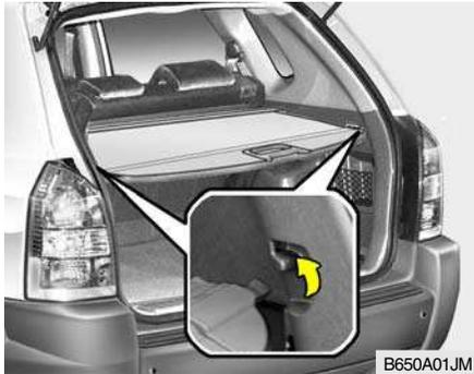
Para utilizar la bandeja de seguridad sacarla del retractor y engancharla al anclaje como se muestra.
