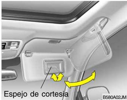
Su vehículo Hyundai está equipado con parasoles para proporcionar protección delantera y lateral contra la luz directa del sol al conductor y al pasajero del asiento delantero. Para bloquear el resplandor de la luz, baje el parasol. En la parte posterior del mismo se ha instalado un espejo de cortesía, tanto en el lado del conductor como en el del acompañante.
