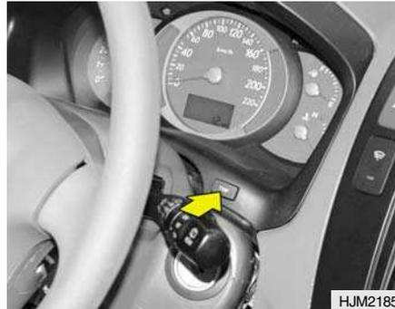
Al pulsar este interruptor, situado detrás de la palanca derecha, la visualización se conmuta como sigue:
