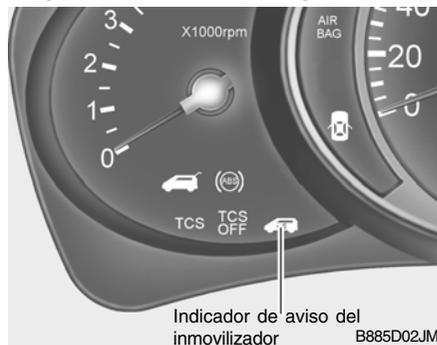
Si al situar la llave de encendido en la posición "ON" el indicador de aviso del inmovilizador parpadea durante cinco segundos, esto indica que su sistema inmovilizador está fuera de servicio. Y entonces sólo podrá arrancar el motor siguiendo los procedimientos del sistema seguridad con la llave de encendido.
