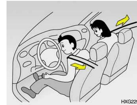
Los cinturones de seguridad con pretensor funcionan de la misma forma que los cinturones de seguridad con bloqueo de retracción de emergencia (ELR). Cuando el vehículo se detiene de forma brusca, o si el ocupante intenta inclinarse hacia delante demasiado deprisa, el retractor se acciona y bloquea el cinturón.
