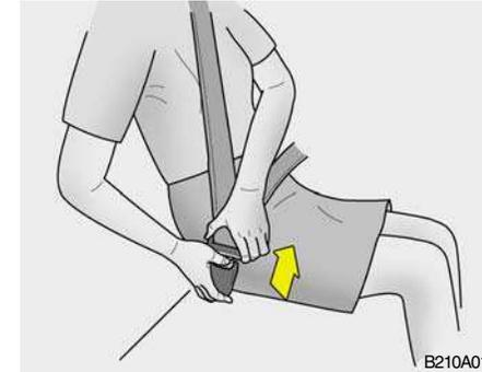
El cinturón puede soltarse, apretando el botón rojo del mecanismo de fijación en el centro del automóvil. Cuando éste se suelta, vuelve automáticamente a su posición original. Si esto no ocurre, verifique que el cinturón no esté torcido, e inténtelo de nuevo.
