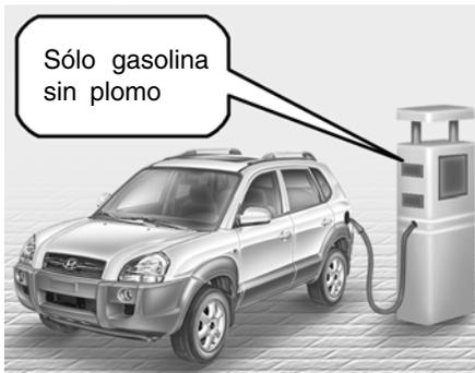
Para obtener un rendimiento óptimo del vehículo recomendamos utilizar gasolina sin plomo de 95 octanos (RON) / AKI 91 o superior. Puede utilizarse gasolina sin plomo de 91~94 octanos (RON) / AKI 87~90, si bien ello podría reducir ligeramente el rendimiento del vehículo.
