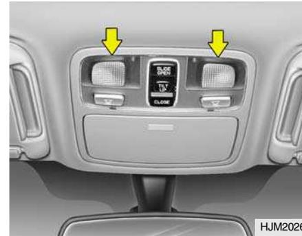
1. Retire la cubierta de plástico rectangular situada en la consola delantera superior.
