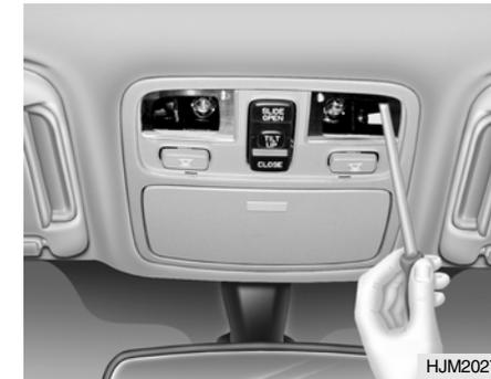
2. Retire los tornillos de montaje de la consola superior delantera con un destornillador (+).
