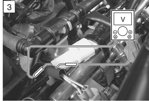
**DATA** STP sensor output voltage
