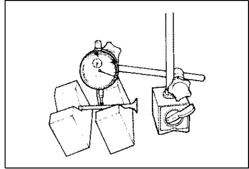
**VALVE HEAD RADIAL RUNOUT**
