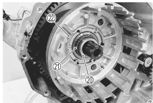
**OIL PUMP DRIVE SPROCKET**
