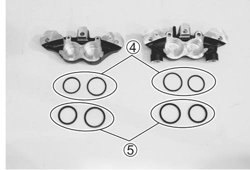
**CALIPER INSPECTION****BRAKE CALIPER**
