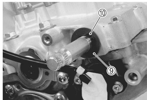
**OIL PUMP DRIVE SPROCKET**
