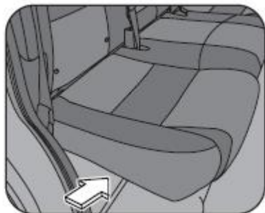
Localización de la palanca del gato y de la llave de ruedas en cabinas dobles
