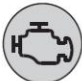
Lámpara indicadora de mal funcionamiento (MIL)
