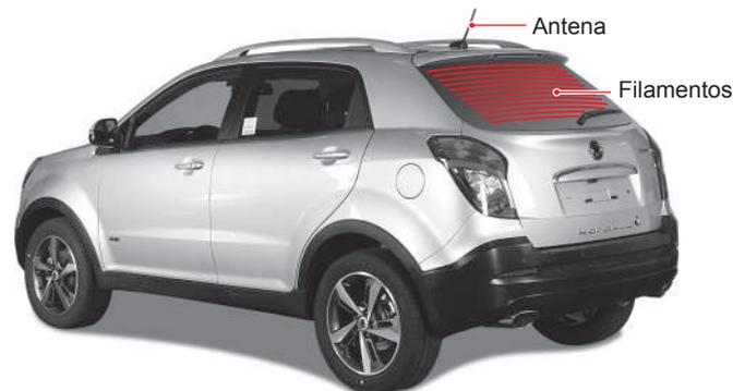
Hay filamentos en la luneta trasera. Tenga cuidado de no dañar los filamentos mientras limpia el interior de la luneta trasera.
