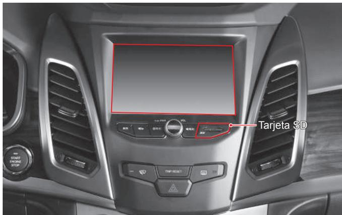
La ranura para insertar la tarjeta de navegación SD se encuentra debajo del panel táctil del monitor de navegación. Para obtener más información sobre este dispositivo, consulte el manual de operación suministrado por separado.
