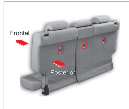
Los herrajes del ancla de sujeción están instalados en los puntos mostrados en la imagen.
