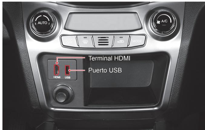
Puede reproducir archivos de música almacenados en la tarjeta de memoria utilizando un puerto USB o utilizando la conexión de la terminal HDMI y aplicaciones en dispositivos inteligentes.
