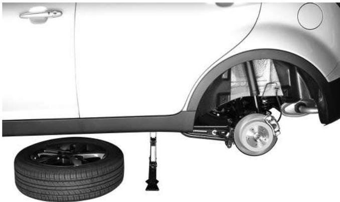
5. Extraiga el neumático y colóquelo debajo de la carrocería del vehículo. Esto minimiza el peligro en caso que el gato se corra de su posición.
