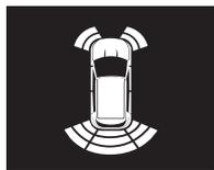
Indica la distancia con respecto al obstáculo en la pantalla LCD junto con señales audibles
