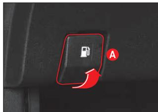
1. Abra la puerta del llenador de combustible (A) jalando la palanca de liberación ubicada en el lado inferior izquierdo del volante.
