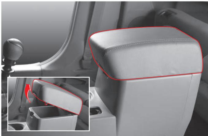
El compartimiento de almacenamiento de la consola central puede utilizarse como arnés tanto para el conductor como para el pasajero. Para abrir el compartimiento de almacenamiento de la consola central, jale el botón.
