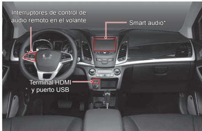
Siendo compatible con los modos USB / HDMI / tarjeta SD / cámara de vista posterior, este sistema de audio puede ser controlado mediante el panel táctil en los interruptores del volante.
