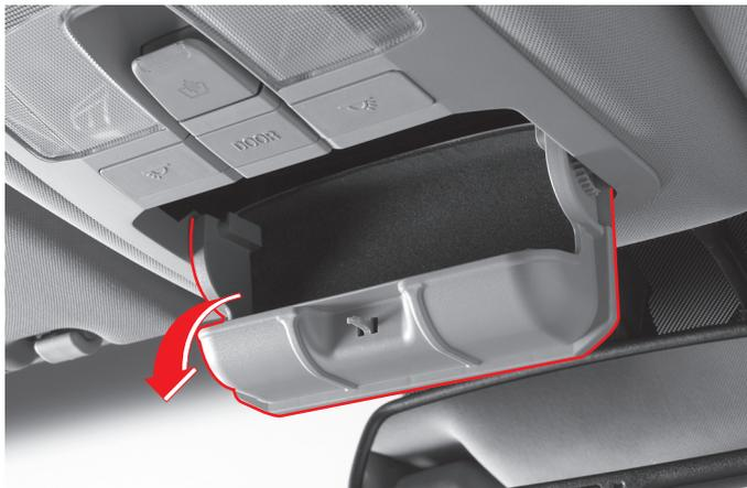
Para abrir el soporte para gafas, presione la cubierta. La cubierta del soporte para gafas se abrirá lentamente.
