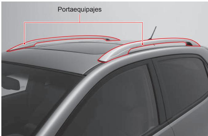
Si el vehículo tiene portaequipajes, puede cargar cosas en la parte superior de éste.
