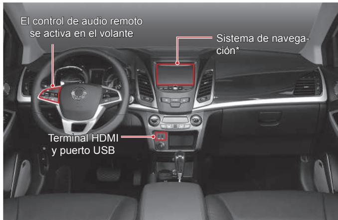
El sistema de navegación puede ser controlado utilizando el panel táctil y los interruptores de control remoto del audio en el volante y la música y video podrán reproducirse conectando un audio externo o el equipo de video a la terminal de entrada HDMI.
