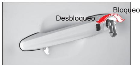
2. Para desbloquear las puertas, gire la llave hacia la dirección de desbloqueo "Unlock".
