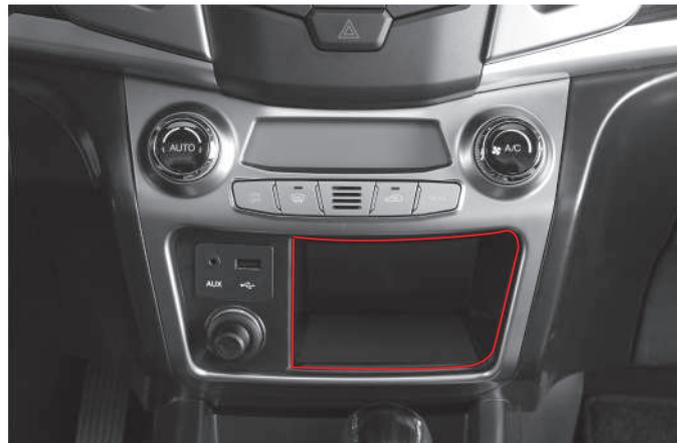
Presione la palanca para abrir el compartimiento de almacenamiento frontal.
