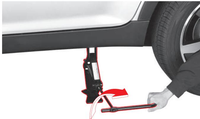
3. Combine el gato, la llave para tuerca de rueda y la conexión del gato como se muestra en la figura. Eleve el vehículo rotando la llave de combinación en el sentido de las agujas del reloj hasta que la goma esté en el piso.
