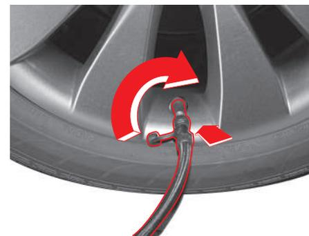
7. Desmonte la tapa guardapolvo de la rueda y fije la válvula de la manguera de aire en la parte inferior de la rosca de la válvula de aire de la llanta.
