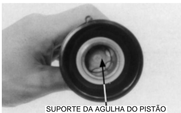
Remova o suporte da agulha, mola ,agulha do pistão e arruela do pistão do carburador. Inspeccione se a agulha do pistão apresenta desgaste excessivo ou está empenada. Inspeccione o diafragma se está deteriorado ou furado. Inspeccione o pistão de vácuo se apresenta desgaste ou danos.
