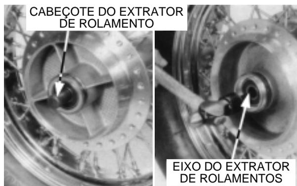
Instale um novo rolamento esquerdo no cubo da roda traseira, perpendicularmente de modo que fique completamente assentado.
