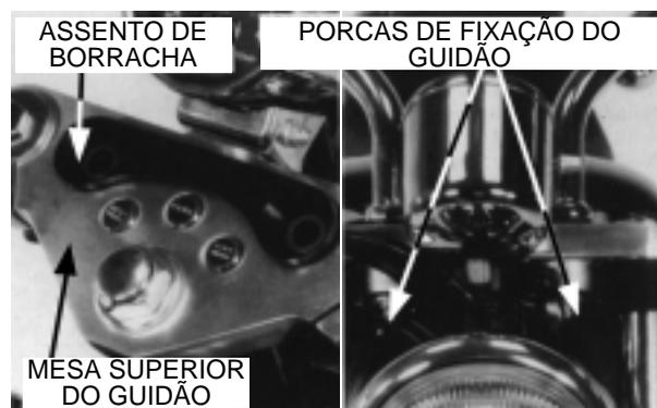
Instale a bucha suporte do interruptor esquerdo do guidão. Alinhe o pino da carcaça dos interruptores com o furo do guidão.
