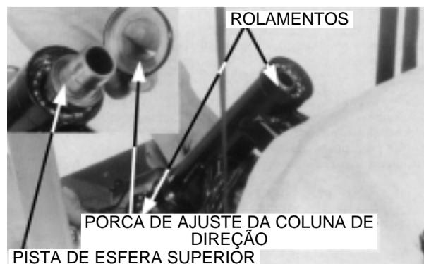
Aperte a porca de ajuste da coluna de direção com o torque especificado.
