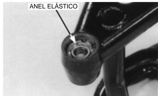
Aplice uma camada de graxa nos lábios dos retentores de pó e instale-os juntamente com as buchas de articulação na posição correta.
