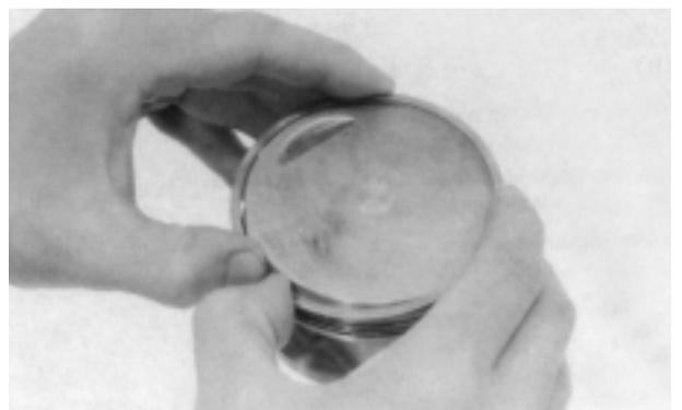
Insira a superfície externa do anel velho na canaleta correta e gire o anel em torno da canaleta para limpá-la.
