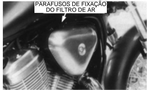
Solte a braçadeira de união da carcaça e câmara do filtro de ar. Desacople o tubo de respiro do motor da carcaça do filtro de ar.
