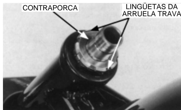
Solte a porca de ajuste do rolamento da coluna de direção.
