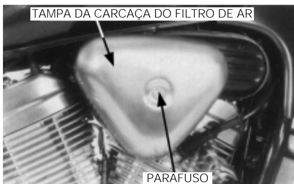
Remova os parafusos, suporte e o elemento do filtro de ar. O elemento do filtro deverá ser trocado de acordo com os períodos indicados na TABELA DE MANUTENÇÃO, ou caso esteja excessivamente sujo ou danificado.
