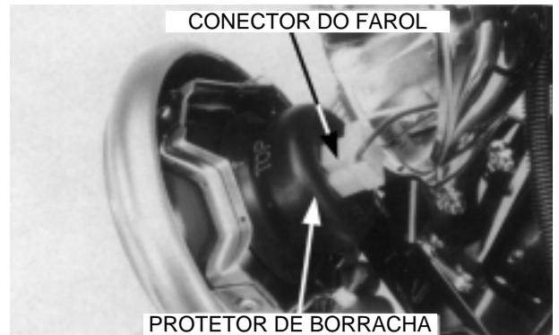
Remova a presilha de retenção e substitua a lâmpada do farol.
