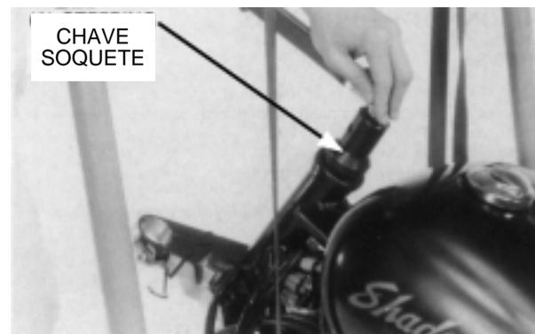
Segure a coluna de direção e remova a porca de ajuste, retentor de pó, pista de esferas superior e rolamento de esferas superior.
