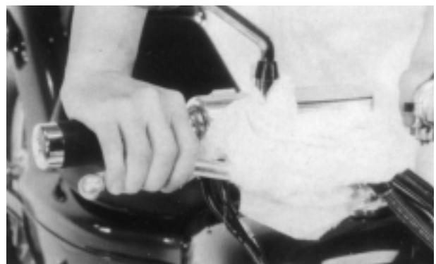
1) Acione a alavanca do freio, abra a válvula de sangria 1/2 volta e depois feche a válvula.
