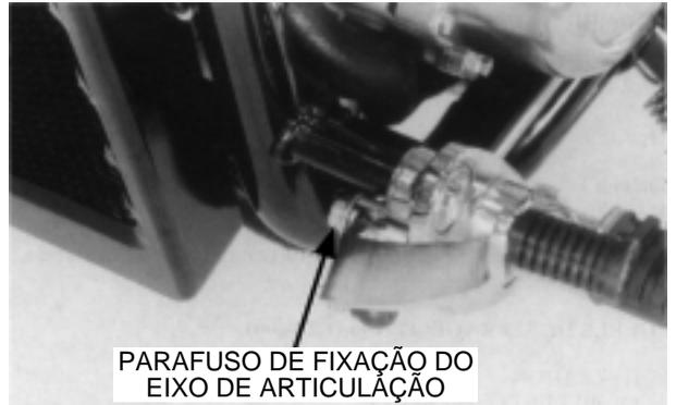
PARAFUSO DE FIXAÇÃO DO EIXO DE ARTICULAÇÃO
