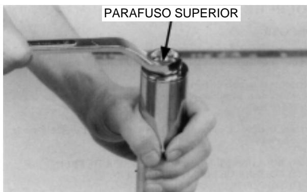
Remova a mola, arruela e espaçador. Retire o fluido, bombeando o amortecedor várias vezes.
