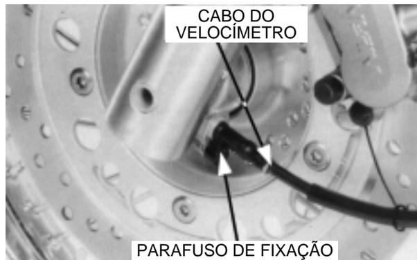
Remova as capas e os parafusos de fixação do eixo do garfo dianteiro.
