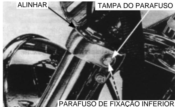
Instale e aperte o parafuso de fixação inferior.
