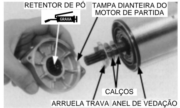
Alinhe a marca de referência da tampa dianteira, carcaça e tampa traseira conforme mostrado.
