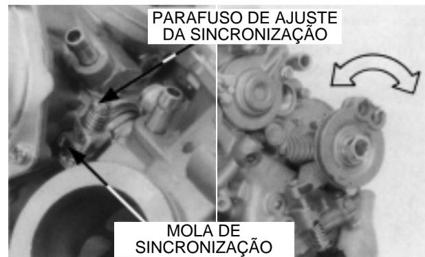
Vire o parafuso de aceleração para alinhar a válvula de aceleração do carburador do cilindro traseiro com a extremidade do furo de passagem.
