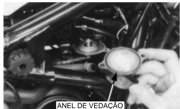
Aperte os parafusos de fixação da tampa do suporte do termostato.
