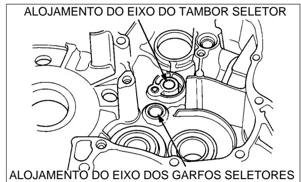
Verifique os furos das engrenagens, furos e dentes se estão com desgaste anormal ou sinais evidentes de falta de lubrificação .
