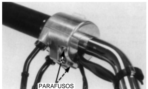
Instale o cilindro mestre com a marca "UP" do suporte voltada para cima.
