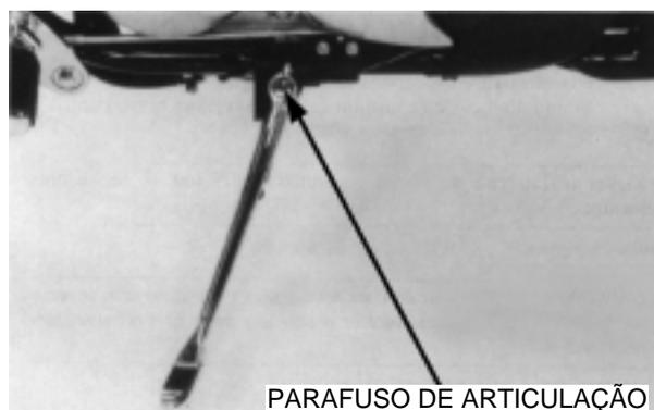
Verifique o sistema de corte de ignição do cavalete lateral.
