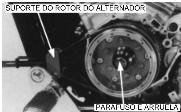
Remova o rotor utilizando o extrator de rotor do alternador.
