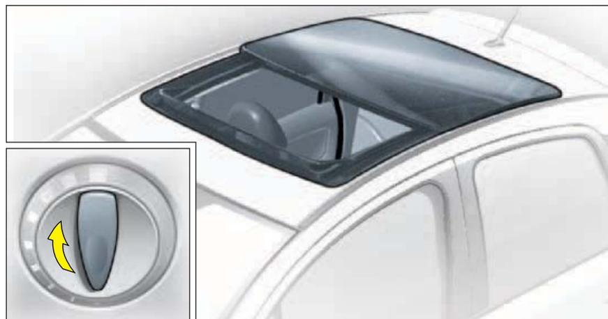
Se acciona mediante un mando eléctrico secuencial, rotativo, con nueve posiciones de apertura, que está situado en el guarnecido de techo, entre los dos parasoles delanteros.
