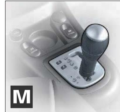
**Observación :** El paso de una marcha a otra solo se produce si lo permiten las condiciones de velocidad y de régimen motor.
