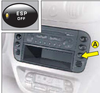
Este sistema está asociado al ABS y lo complementa. En caso de divergencia entre la trayectoria seguida por el vehículo y la deseada por el conductor, el sistema ESP actúa automáticamente sobre el freno de una o más ruedas y sobre el motor para situar el vehículo en la trayectoria deseada.
