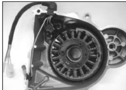
**Estator: (Bobina de estator trifásico)**
