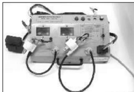
**Bobinas de alta: (Inspección usando multímetro)**
