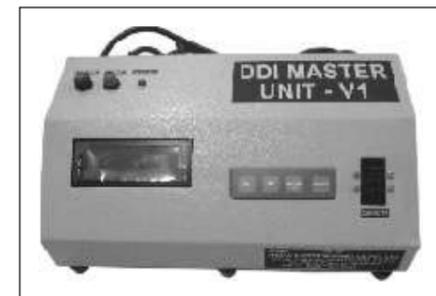
Conectar el cordón de energía de 230V, 50Hz AC al DMU y el cordón de energía en el tomacorriente.
