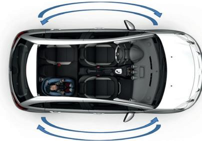
**i** No efectuar rotación cruzada de los neumáticos, desplazando ellos en el lado derecho del vehículo a la izquierda y viceversa. vice-versa.
