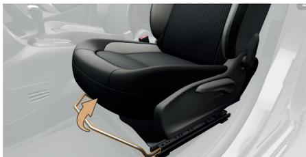
☞ Levante el mando y deslice el asiento hacia delante o hacia atrás.
