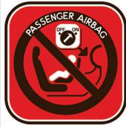
**ATENCIÓN.** No instale un asiento para niños en el asiento delantero, pues el airbag del asiento delantero de pasajero no puede ser neutralizado. En caso de accidente y accionamiento del airbag, el niño puede sufrir heridas graves, inclusive con riesgo de muerte. Utilice siempre un asiento para niños que cumpla los requisitos de las Normas de Seguridad vigentes en su país.
