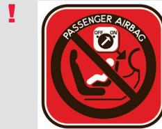
**ATENCIÓN.** No instale un asiento para niños en el asiento delantero, pues el airbag del asiento delantero de pasajero no puede ser neutralizado. En caso de accidente y accionamiento del airbag, el niño puede sufrir heridas graves, inclusive con riesgo de muerte. Utilice siempre un asiento para niños que cumpla los requisitos de las Normas de Seguridad vigentes en su país.
