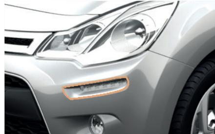
**i** Las luces diurnas no funcionan cuando las luces de posición o los faros del vehículo estén encendidos, pues pueden deslumbrar al conductor que viene en el sentido opuesto, pudiendo acarrear algún accidente. Las luces diurnas no pueden tener su funcionamiento deshabilitado (borradas).
