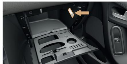
Suelte la tapa con un destornillador fino para acceder a la lámpara defectuosa.
