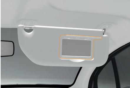
Los parasoles están provistos de un espejo de cortesía cubierto con una tapa.
