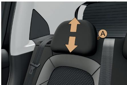
El asiento trasero 1/3 - 2/3 está equipada con apoyacabezas escamoteables. Tienen una posición alta (confort y seguridad) y una posición baja (visibilidad trasera).
