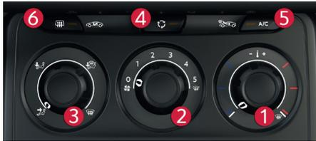
Los sistemas de calefacción/ventilación o de aire acondicionado sólo pueden funcionar con el motor en marcha.
