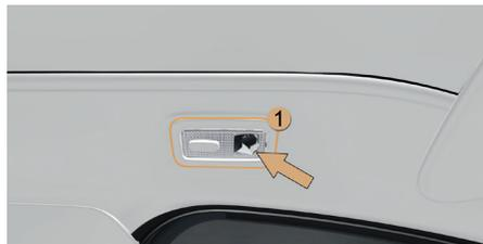
Suelte la tapa de la luz de techo 2 con un destornillador fino, en el lado del mando, para acceder a la lámpara defectuosa.
