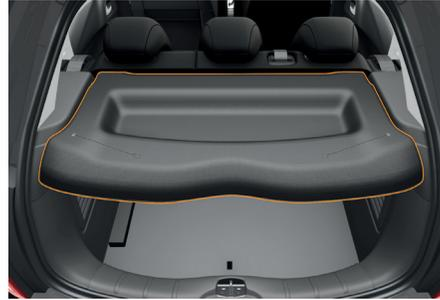
La parte trasera está fijada al portón del baúl mediante dos cordones.
