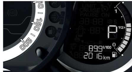
Cuando se desplaza la palanca por la rejilla para seleccionar una posición, el testigo correspondiente se enciende en el tablero de instrumentos.
