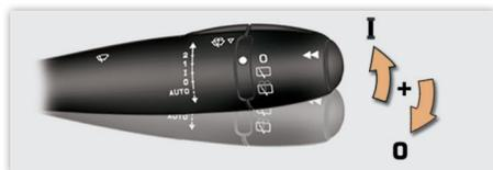
La interrupción se acciona manualmente desde el puesto del conductor, desplazando el mando hacia arriba y volviéndolo a poner en la posición "0".
