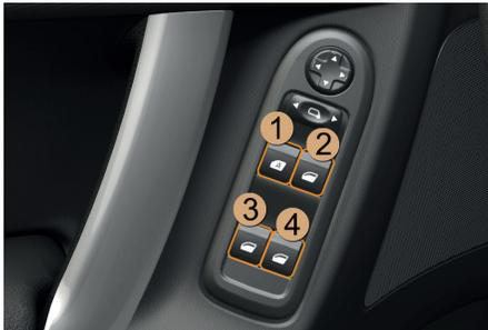
1. Interruptor de levantavidrios eléctrico conductor.
