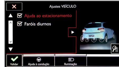
Para neutralizar o activar la función de ayuda al estacionamiento trasero, ingrese al **Menú** del sistema multimedia con pantalla táctil, luego ingrese a **Ajuste Vehículo**. Seleccione o anule la opción Ayuda al Estacionamiento Trasero y active/desactive los "Sensores de estacionamiento".
