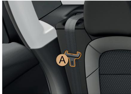
**!** Los cinturones de seguridad funcionan correctamente solamente si están clipados correctamente. Asegúrese de que cada cinturón esté clipado en el respectivo alojamiento.
