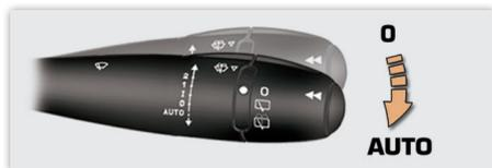
La activación se realiza manualmente desde el puesto del conductor, accionando hacia abajo el mando hasta la posición "AUTO".
