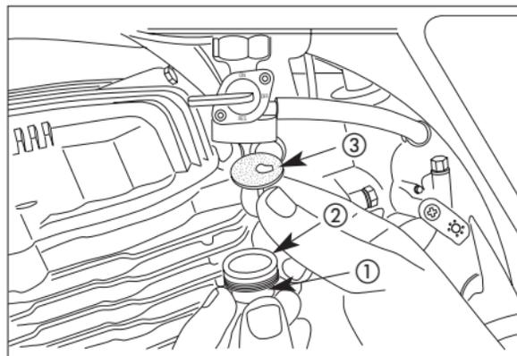
4. Reinstale la malla del filtro en el cuerpo del registro alineando las marcas de referencia. Reemplace manualmente, la tasa del filtro, asegurándose que el anillo de sellar esté en su posición correcta. A continuación, apriete la tasa del filtro.
