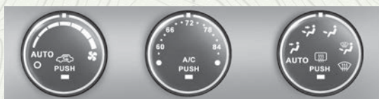
Control automático de temperatura
