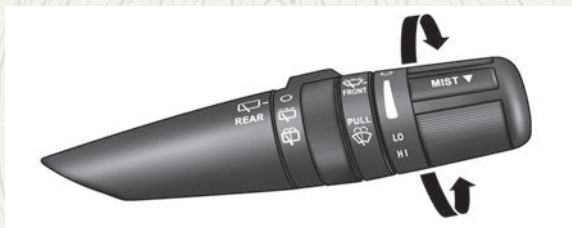
Operación del limpiaparabrisas
