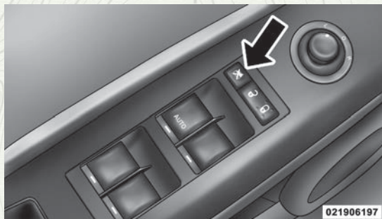
Localización del interruptor de bloqueo de las ventanas
