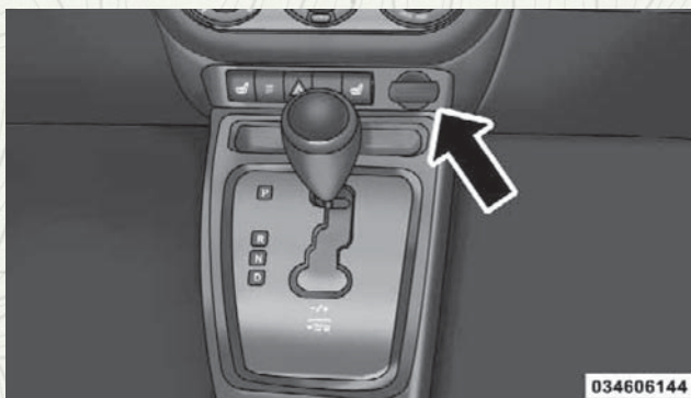
Toma de corriente de 12 Volts
