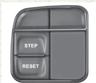
Botones de los controles de la mini computadora de viaje
