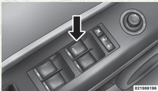
Localización de los interruptores de las ventanas eléctricas
