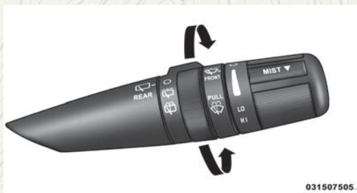
Control del limpiador/lavador trasero
