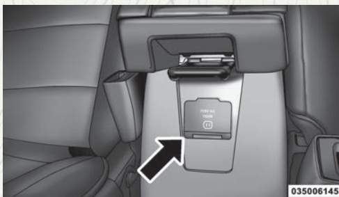
Toma de corriente de 115 Volts
