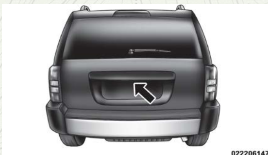
Localización de la manija de la compuerta trasera
