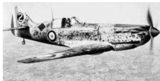
Chasseur Dewoitine D.520 à moteur 12 Y-45 de 910 ch, l'ultime développement opérationnel du V12 Hispano-Suiza. (Cliché Musée de l'Air).
