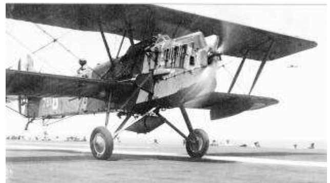
Levasseur PL-7 à moteur Hispano-Suiza 12 Lbrx de 580 ch. (Cliché Musée de l'Air).
