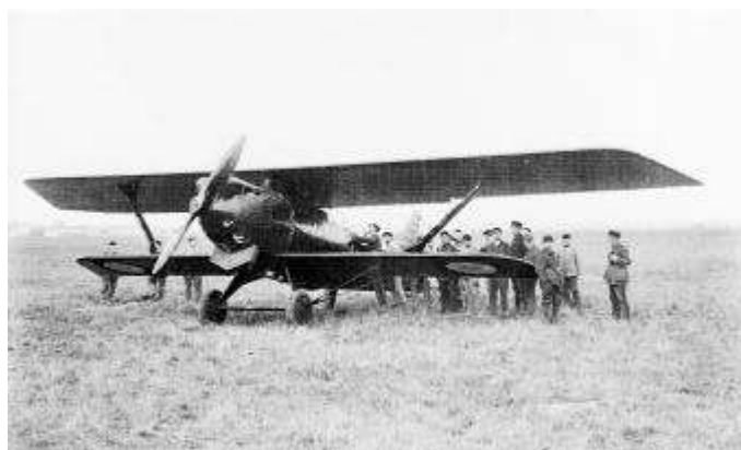
Breguet 19 « grand raids » à moteur Hispano-Suiza 12 N de 550 à 750 ch (1926-1930).
