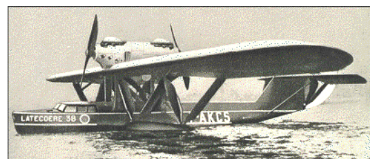
Latécoère transatlantique à deux moteurs 12 N de 650 ch (Laté 380) ou 12 Ydrs.2 de 890 ch (Laté 381). (Cliché constructeur, 1931).
