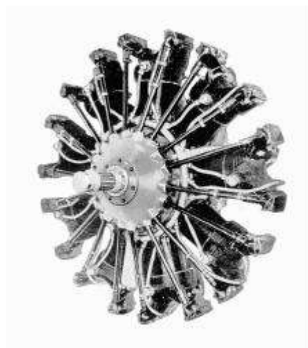
Moteur Hispano-Suiza type 9V de 575 ch (1933). Catalogue constructeur.
