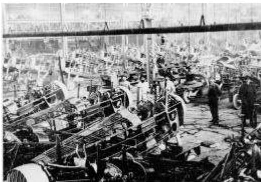
Chasseurs SPAD S.VII en construction chez Blériot à Suresnes en 1916. (Cliché Musée de l'Air).
