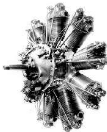
Moteur Hispano-Suiza diesel type 9T 300 ch d'origine Clerget. (Collection M-H Clerget).
