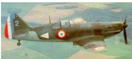
Dewoitine D.520S à moteur Hispano-Suiza 12 Y-45 de 910 ch, avec lequel le fin chasseur atteint 530 km/h. (Cliché J B Salis).
