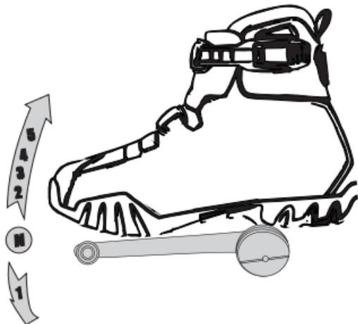
La palanca vuelve a su posición inicial y queda lista para seleccionar otro cambio. Empuje hacia arriba para aumentar los cambios y hacia abajo se disminuye. La neutra se encuentra entre primera y segunda, para situar la motocicleta en este cambio se debe tener una velocidad igual a cero.
