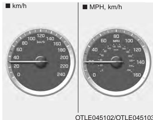
El velocímetro indica la velocidad del vehículo y se calibra en kilómetros por hora (km/h) y/o millas por hora (MPH).
