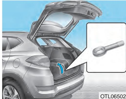
1. Abra el portón y saque el gancho de remolque de la caja de herramientas.
