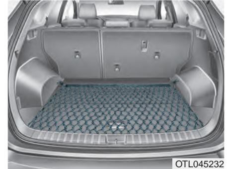
Para evitar que se muevan los objetos que se dejan en el maletero, se pueden usar las cuatro (o seis) anillas allí dispuestas para sujetar la red.
