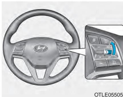
Mueva la palanca (1) hacia arriba (RES+). Si la velocidad del vehículo es superior a 30 km/h, el vehículo recuperará la velocidad preajustada.
