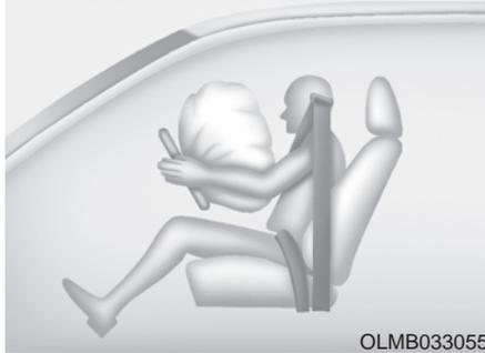
Al desplegarse, las líneas de rotura formadas en el revestimiento se abren bajo la presión producida por la expansión del airbag. Cuando las tapas terminan de abrirse, los airbags pueden inflarse totalmente.
