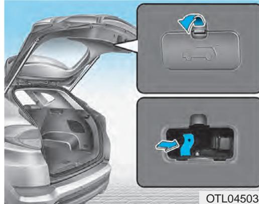
Su vehículo está equipado con una palanca de apertura de emergencia del portón situada en la parte inferior de éste. Cuando se bloquea inintencionadamente el compartimento del maletero, el portón trasero puede abrirse como sigue:
