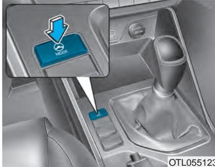
El volante de dirección flexible controla la tensión del volante según la preferencia del conductor y las condiciones de la calzada.
