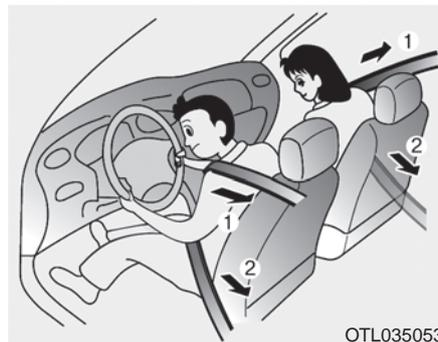
El vehículo viene equipado con pretensores del cinturón de seguridad del conductor y acompañante (Pretensor del retractor y dispositivo de sujeción de emergencia (EFD)). El objetivo de los pretensores es garantizar que los cinturones se ajusten de forma ceñida al cuerpo del ocupante en ciertas colisiones frontales. Los pretensores del cinturón de seguridad pueden activarse en colisiones, junto con los airbags, cuando la colisión frontal sea lo bastante fuerte.
