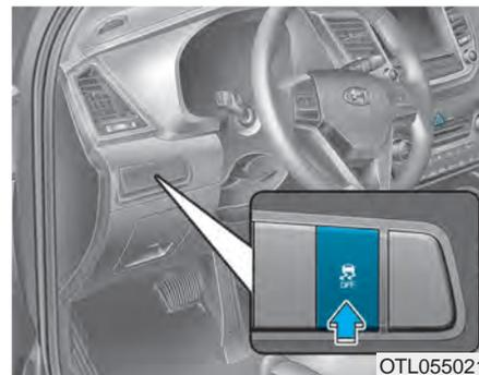
El sistema de control electrónico de estabilidad (ESC) permite estabilizar el vehículo durante maniobras en curvas.
