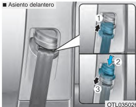
Para regular la altura del cinturón de seguridad, suba o baje el ajuste de altura hasta una posición adecuada.
