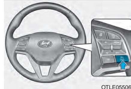
1. Pulse el botón en el volante, y después pulse el botón para activar el sistema. Se encenderá el testigo indicador de límite de velocidad en el tablero de instrumentos.
