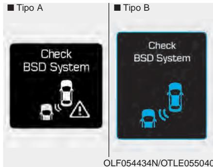
Si existe un problema con el sistema de detección de ángulo muerto, aparece un mensaje de advertencia y el testigo del interruptor se apaga. El sistema se apaga automáticamente. Recomendamos que haga revisar el vehículo por un distribuidor HYUNDAI autorizado.
