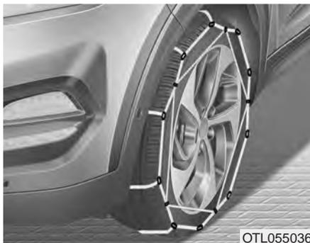
Ya que las paredes laterales de los neumáticos radiales son más finas que las de otros tipos de neumáticos, podrían dañarse si se montan cierto tipo de cadenas en ellos. Por tanto, se recomienda usar neumáticos para nieve en lugar de las cadenas. No monte cadenas en vehículos con llantas de aluminio. Si es imprescindible, use una cadena tipo cable. Si es necesario usar cadenas, use piezas originales HYUNDAI y revise las instrucciones suministradas con las cadenas antes de montar las mismas.
