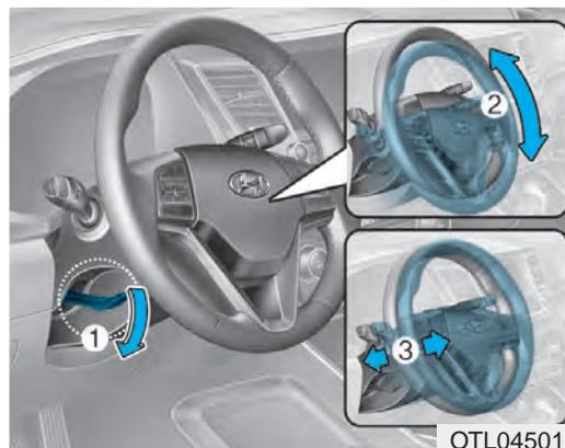
Tire hacia abajo la palanca de liberación del bloqueo (1) situada en la columna del volante y ajuste el ángulo (2) y la posición (3) del volante. Mueva el volante de modo que se dirija hacia su pecho, no hacia su cara. Asegúrese de que puede ver los testigos de advertencia y los indicadores en el panel de instrumentos.
