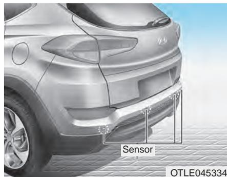
El sistema de ayuda al estacionamiento trasero ayuda al conductor en el movimiento de marcha atrás del vehículo emitiendo una señal acústica si se detecta algún objeto a una distancia de 120 cm detrás del vehículo.
