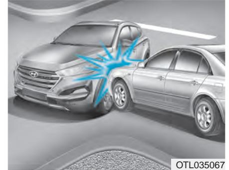
Los airbags delanteros no se inflarán en las colisiones de impacto lateral porque los ocupantes se mueven en la dirección de la colisión; es decir, en los impactos laterales, el despliegue del airbag delantero no ofrecería ninguna protección adicional.
