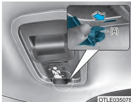
4. Introduzca la placa de lengüeta (A) en el orificio en la cubierta del conjunto del cinturón.
