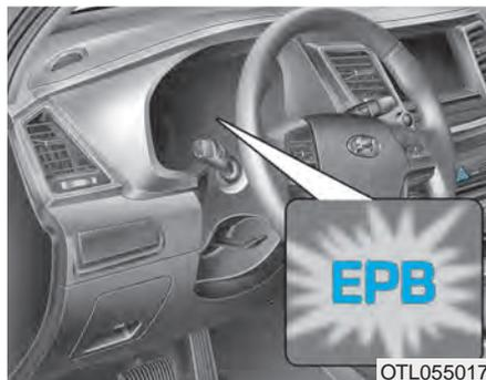
Si el indicador de avería del EPB permanece encendido, se enciende durante la conducción o no se enciende al colocar el botón de inicio/parada del motor a ON, esto indica que el EPB podría tener una avería.
