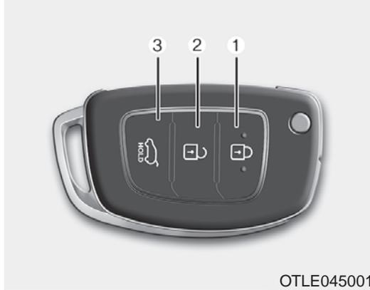
Su HYUNDAI utiliza una llave a distancia que puede utilizar para bloquear o desbloquear una puerta (y el portón trasero) e incluso arrancar el motor.
