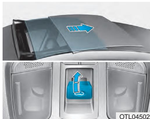
Al tirar de la palanca de control del techo solar hacia atrás hasta la segunda posición de detención, el parasol se deslizará hasta abrirse completamente y luego el cristal del techo solar se deslizará hasta abrirse completamente. Para detener el movimiento del techo solar en algún punto, tire o empuje la palanca de control del techo solar brevemente.
