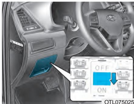
Coloque siempre el interruptor de control del fusible a ON.
