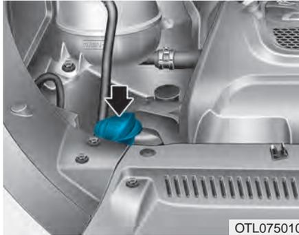
El depósito es translúcido para que se pueda comprobar el nivel con una rápida inspección visual.
