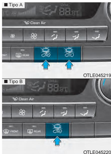
Se utiliza para seleccionar entre admisión de aire exterior (fresco) o recirculación del aire.
