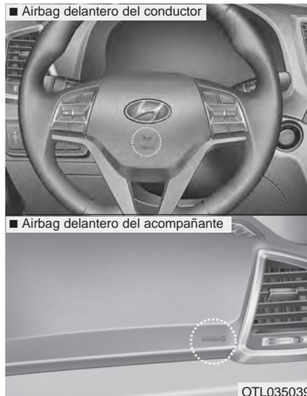
Su vehículo está equipado con un sistema de sujeción suplementario (SRS) y cinturones de seguridad con banda abdominal/del hombro tanto en el asiento del conductor como en el del acompañante.
