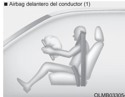
Cuando el SRSCM detecta un impacto frontal suficientemente fuerte, despliega automáticamente los airbags delanteros.
