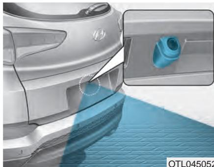
La cámara de visión trasera se activa cuando el motor está en marcha y la palanca de cambio está en la posición R (marcha atrás).
