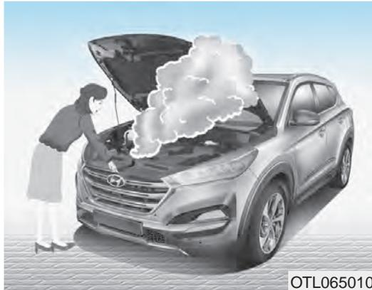
Si el indicador de temperatura indica sobrecalentamiento, nota una pérdida de potencia o escucha un ruido de picado, significa que el motor está sobrecalentado. Si esto ocurriese, proceda como sigue:
