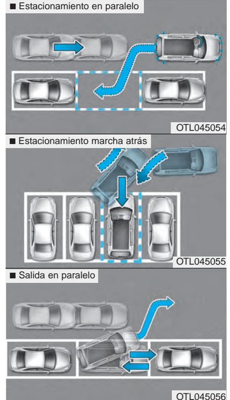
El sistema de ayuda al estacionamiento inteligente ayuda a los conductores a aparcar el vehículo utilizando los sensores para medir espacios de aparcamiento, controlando el volante para aparcar el vehículo de forma semiautomática y proporcionando instrucciones en la pantalla LCD que ayudan a aparcar. Además el sistema proporciona asistencia al abandonar (salida en paralelo) una plaza de aparcamiento.
