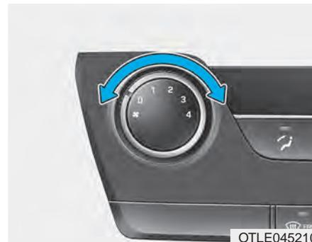
El contacto debe estar encendido (ON) para que funcione el ventilador. El control de velocidad del ventilador permite regular la velocidad del aire del sistema de ventilación. Para cambiar la velocidad del ventilador, gire el mando hacia la derecha para aumentarla y hacia la izquierda para reducirla.
