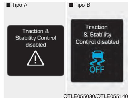
Pulse el botón ESC OFF durante más de 3 segundos. El testigo indicador ESC OFF se encenderá, aparecerá un mensaje y sonará una señal acústica de aviso de ESC OFF. En este estado, la función de control del motor y la función de control de los frenos no están operativas. La función de control de estabilidad del vehículo no está operativa.
