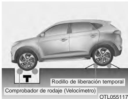
Un vehículo 4WD a tiempo completo no debe ser probado en un comprobador de rodaje para vehículos de tracción a 2 ruedas. Si se debe usar un comprobador de rodaje para 2WD, lleve a cabo el siguiente procedimiento:
