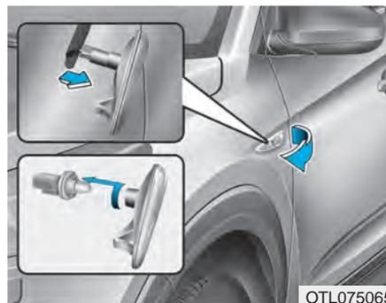
1. Desmonte el conjunto de la luz del vehículo haciendo palanca en la lente y tirando del conjunto hacia fuera.
