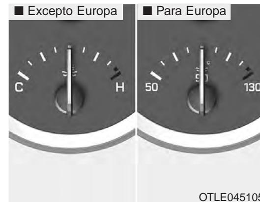
Este indicador muestra la temperatura del refrigerante del motor cuando el interruptor de encendido se encuentra en la posición ON.
