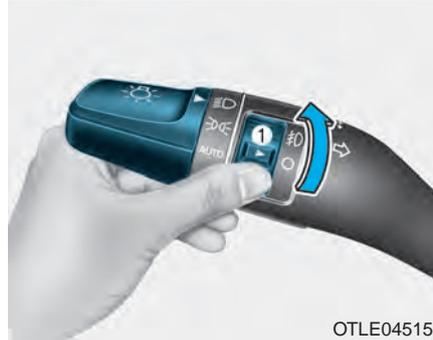
Las luces antiniebla sirven para mejorar la visibilidad en caso de niebla, lluvia o nieve. Accione el interruptor junto al de los faros para encender y apagar las luces antiniebla.
