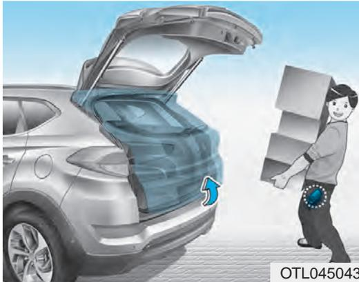
En los vehículos equipados con una llave inteligente, el portón trasero puede abrirse sin una activación por contacto usando el sistema del portón trasero inteligente.
