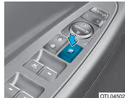
El conductor puede desactivar los interruptores de los elevalunas eléctricos de las puertas traseras pulsando el interruptor de bloqueo de los elevalunas eléctricos.
