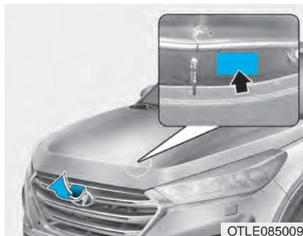
La etiqueta de refrigerante le suministra información sobre el tipo y la cantidad de refrigerante. La etiqueta está colocada en la parte inferior del capó.
