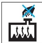
**No retire la tapa del radiador ni el tapón de drenaje si el motor o el radiador está caliente. Podría salir refrigerante o vapor caliente a presión y causar lesiones graves.**
