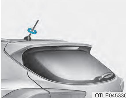
La antena del techo recibe señales de emisión tanto AM como FM. Para desmontar la antena del techo, gírela en sentido antihorario. Para volver a montarla, gírela en sentido horario.
