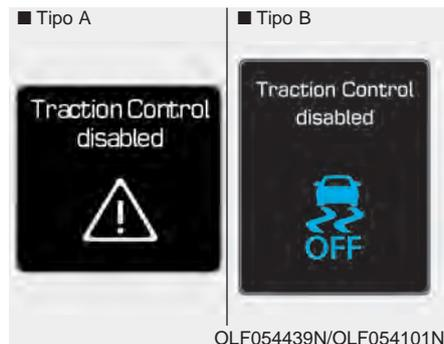
Pulse brevemente el botón ESC OFF (el testigo indicador ESC OFF se ilumina y aparece un mensaje). En este estado, la función de control del motor no está operativa. La función de control de la tracción no está operativa, solo está operativa la función de control de los frenos.
