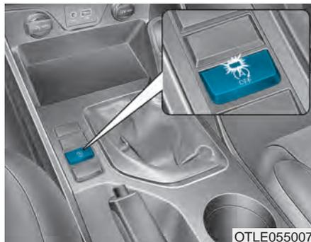
Cuando el conductor se desabrocha el cinturón de seguridad o abre la puerta del conductor (o el capó) en el modo de parada automática, ocurrirá lo siguiente:
