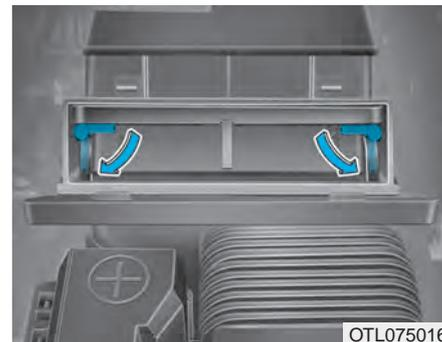
3. Baje la palanca a la posición UNLOCK (desbloqueo).
