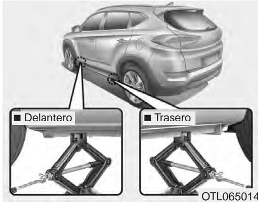
7. Sitúe el gato en la posición designada para el mismo debajo del bastidor junto a la rueda que desee cambiar. Las posiciones para el gato son placas soldadas al bastidor con dos muescas y dos cavidades. No coloque el gato en ninguna otra posición ni parte del vehículo. Podría dañar la moldura lateral.
