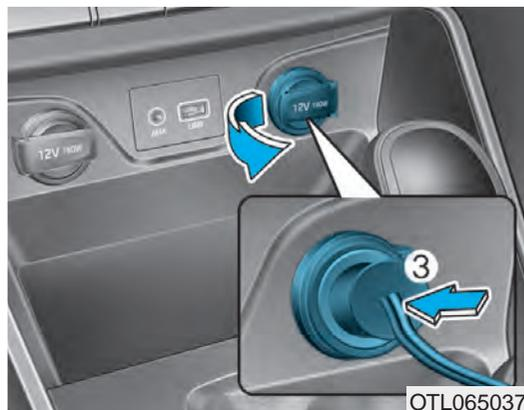
7. Conecte el compresor y la batería del vehículo con el cable y los conectores.
