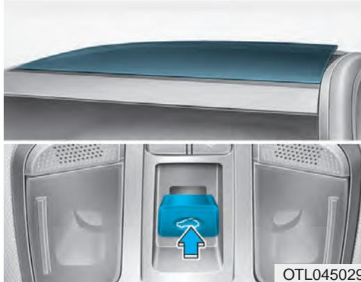
Al empujar la palanca de control del techo solar hacia arriba, el parasol se abrirá y el cristal del techo solar se inclinará.
