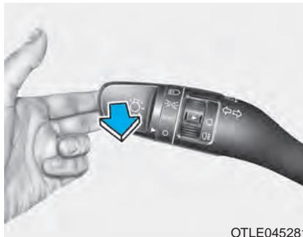
Para hacer ráfagas con las luces de carretera, tire de la palanca hacia usted y suéltela. Las luces de carretera se encenderán durante el tiempo que mantenga la palanca sujetada hacia usted.
