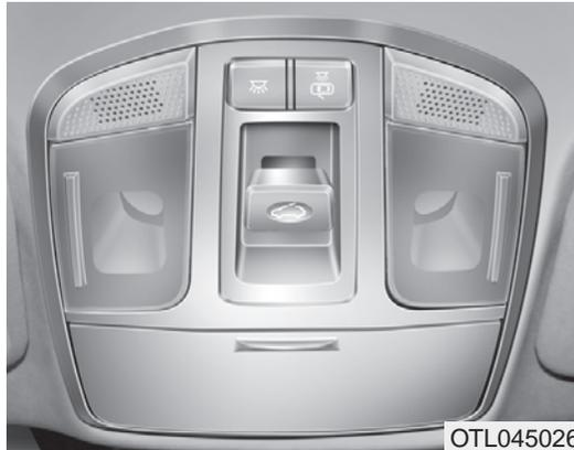
Si su vehículo está equipado con un techo solar, puede deslizar o inclinar el techo solar con la palanca de control ubicada en la consola superior.
