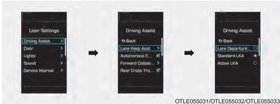
El conductor puede cambiar el LKAS al sistema de aviso de salida de carril (LDWS), o conmutar el modo LKAS entre LKA estándar y LKA activo en el modo de ajustes del usuario de la pantalla LCD. El sistema se ajusta automáticamente a LKA estándar si no se selecciona ninguna función.
