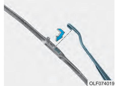
3. Instale el nuevo conjunto de la escobilla siguiendo el proceso de desmontaje en sentido inverso.
