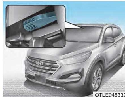
El sistema de desempañamiento automático reduce la probabilidad de empañamiento en el interior del parabrisas al detectar automáticamente la humedad del interior del parabrisas.
