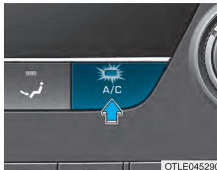
Pulse el botón A/C para poner en marcha el sistema de aire acondicionado (se ilumina la luz indicadora). Pulse de nuevo el botón para desconectarlo.
