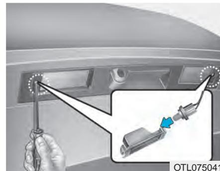
1. Afloje los tornillos de fijación de la lente con un destornillador.
