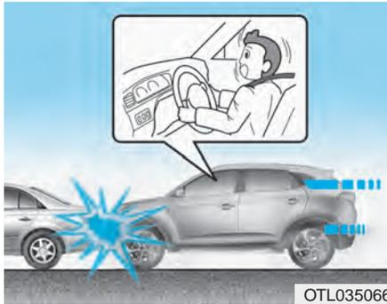
En ciertas colisiones a baja velocidad los airbags puede que no se desplieguen. Los airbags no están diseñados para actuar en estos casos porque no proporcionan ninguna ventaja añadida a los cinturones de seguridad.
