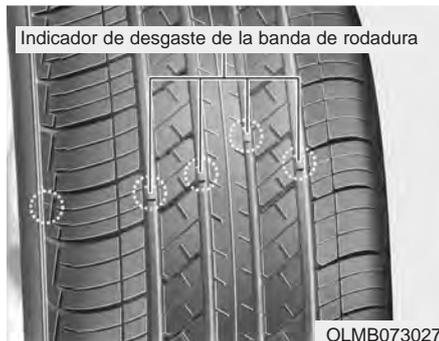
Si el neumático está gastado uniformemente, aparecerá un indicador de desgaste de la banda de rodadura en forma de una banda sólida transversal. Esto indica que quedan menos de 1,6 mm de banda de rodadura. Es el momento de sustituir el neumático.
