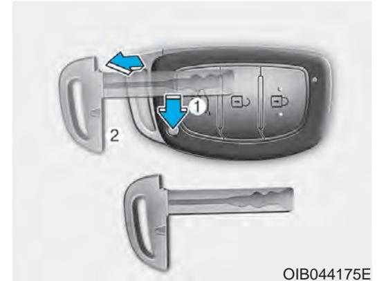
Pulse y mantenga pulsado el botón de liberación (1) y extraiga la llave mecánica (2). Introduzca la llave mecánica en el orificio para la llave en la puerta.
