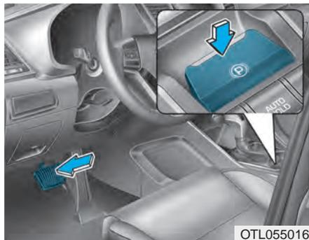
**Para soltar el EPB (freno de estacionamiento eléctrico), pulse el interruptor EPB como sigue:**
