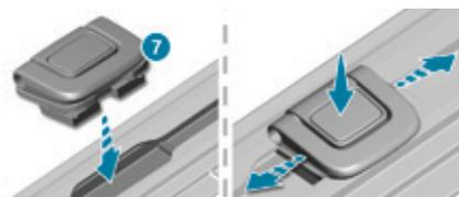
7. Anillas de sujeción de la red (retención de equipaje) (según versión)
