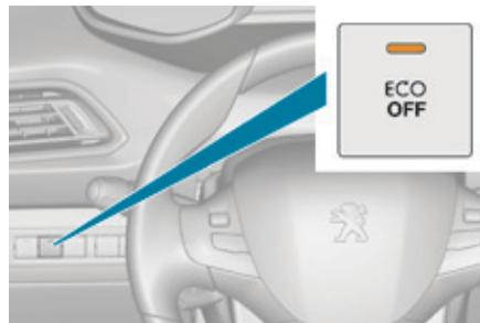
En caso de fallo de funcionamiento del sistema, este testigo se enciende de manera fija. Lleve a revisar el sistema a la red PEUGEOT o a un taller cualificado.
