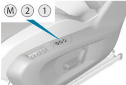
Sistema que permite memorizar los reglajes eléctricos del asiento del conductor.
