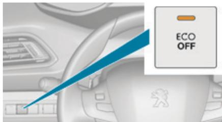
Pulse el mando " **ECO OFF** " en cualquier momento para neutralizar el sistema. Esto se indica mediante el encendido del piloto del mando, acompañado de un mensaje.
