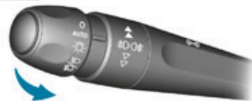
Tire del mando para conmutar el encendido de las luces de cruce/carretera.
