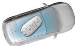
Con la llave electrónica del Acceso y arranque manos libres en el interior del vehículo, pulsar el botón "START/STOP", **sin pisar ningún pedal**, permite poner el contacto. Esto también permite activar los accesorios (ejemplo: radio, alumbrado...).
