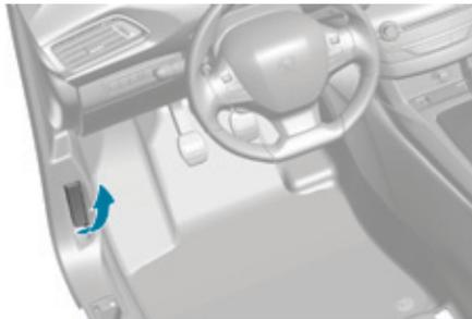
☞ Tire hacia usted del mando situado en la parte inferior del marco de la puerta.
