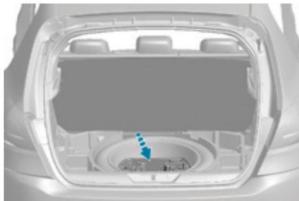
El utillaje está instalado debajo del suelo del maletero.
