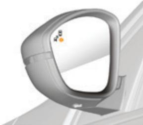
Cada retrovisor está equipado con un espejo regulable que permite la visión trasera lateral necesaria para las situaciones de adelantamiento o estacionamiento. Los retrovisores pueden plegarse para estacionar en lugares estrechos.
