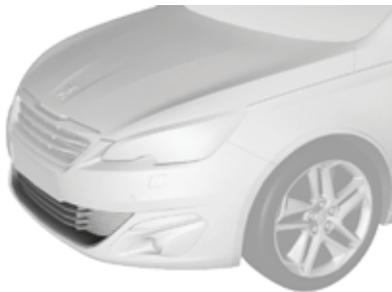
**i** El funcionamiento del radar, situado en el paragolpes delantero, puede verse perturbado en determinadas condiciones meteorológicas, por ejemplo, cuando se acumula nieve, hielo o barro sobre él. Limpie el paragolpes delantero retirando la nieve, el barro, etc.
