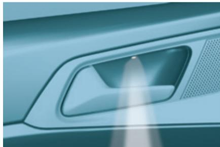
De noche, la luz de los mandos de apertura interior de las puertas delanteras se enciende automáticamente al encender las luces de posición.
