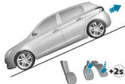
**En pendiente descendente, con el vehículo parado y la marcha atrás introducida, el vehículo se mantiene un momento después de soltar el pedal del freno.**
