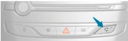
La entrada de aire exterior evita la formación de vaho en el parabrisas y las lunas laterales. El reciclado del aire interior permite aislar el habitáculo de los olores y humos exteriores.
