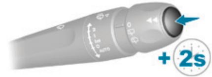
☞ Cuando el recorrido deseado aparezca en pantalla, pulse durante más de dos segundos el botón situado en el extremo del mando del limpiaparabrisas.
