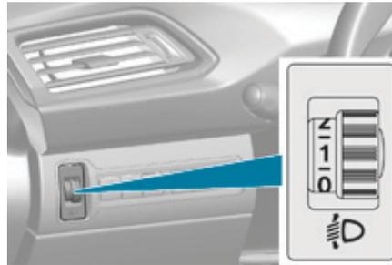
Para no molestar a los demás usuarios de la vía, es necesario regular la altura de los faros con lámparas halógenas en función de la carga del vehículo.
