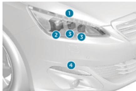
1. Luces diurnas/de posición (diodos electroluminiscentes-LEDs).
