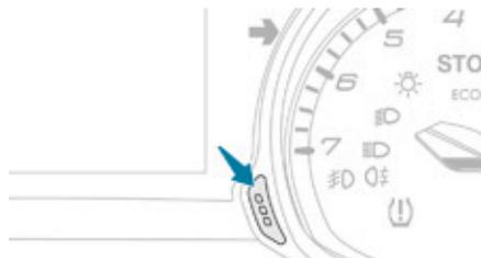
Después de cada revisión, debe poner a cero el indicador de mantenimiento.
