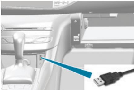
Permite conectar un dispositivo portátil, como un reproductor digital de tipo iPod® o una llave USB.
