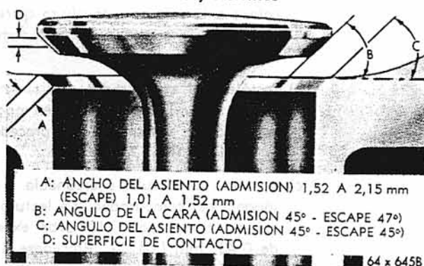
Fig. 8 - Angulos de la Cara y Asiento de Válvulas.
