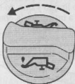
El tapón de llenado de aceite del motor es de cierre por rotación y clic. Para abrir, gire el tapón en sentido contrario a las agujas del reloj. No quite el tapón estando el motor en marcha.
