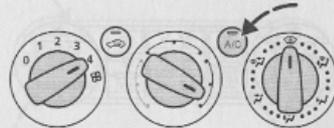
Entra aire exterior al vehículo. Mientras se halla el mando de distribución del aire en la posición , se conecta automáticamente el aire acondicionado. Cerciórese de que está conectado el soplador. La luz del interruptor **A/C** se enciende durante el deshielo/desempeñado.
