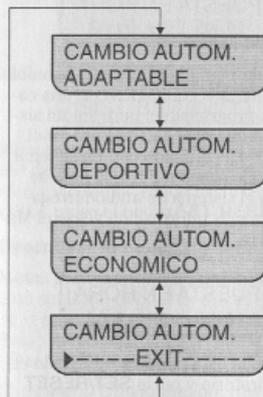
La pantalla muestra el ajuste seleccionado actualmente. Para elegir un ajuste distinto, apriete el botón **SET/RESET**. A continuación utilice el mando giratorio para rodar por las configuraciones disponibles y pulse el botón **SET/RESET** para seleccionar la que desee. En la pantalla del ajuste seleccionado aparece un tic.
