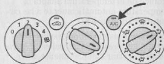
Conectando el aire acondicionado se elimina la humedad del aire y las ventanillas se desempañan más rápidamente.
