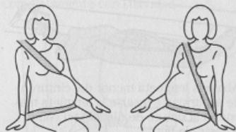
La parte inferior del cinturón debe colocarse confortablemente cruzando las caderas, por debajo del abdomen. La parte diagonal del cinturón debe colocarse entre los pechos, y llevarse por encima del abdomen a un lado del mismo.
