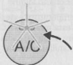
Para conectar y desconectar el efecto de refrigeración, pulse el interruptor **A/C**.
