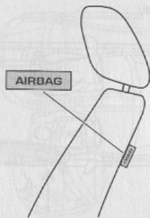
Una etiqueta situada en el respaldo indica que hay instalados airbags laterales. Los airbags laterales se hallan instalados en el lado de los respaldos de los asientos delanteros. En el caso de una colisión lateral grave, el airbag del lado afectado por la colisión se infla.
