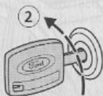
Con la llave: Coloque la llave en la puerta del conductor y gírela a la posición ② dos veces en el intervalo de tres segundos.
