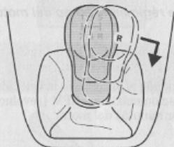
Para seleccionar la marcha atrás, desplace la palanca del cambio hacia la derecha y hacia atrás.
