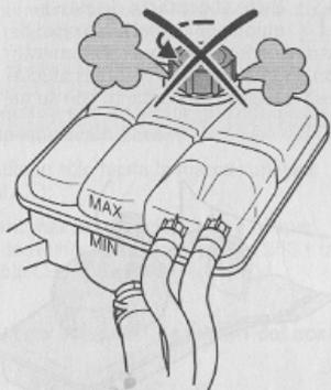
⚠ Para no escaldarse, no retire nunca el tapón del depósito de refrigerante cuando esté caliente el motor. No vuelva a arrancar el motor antes de haber eliminado el problema.
