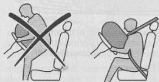
⚠ Lleve siempre abrochado el cinturón de seguridad y mantenga una distancia suficiente con respecto al volante. Sólo utilizando el cinturón de seguridad correctamente puede éste sujetar el cuerpo en una posición que permita al airbag conseguir una máxima efectividad. Existe el riesgo de lesiones al desplegarse el airbag.
