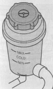
El nivel de líquido de la dirección asistida debería llegar hasta la marca **MAX** con el motor frío.
