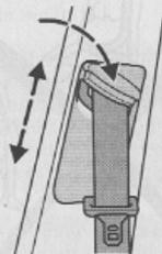
Apriete el botón de bloqueo en el dispositivo de ajuste de altura y desplace el pivote de forma que el cinturón descanse sobre el centro del hombro.
