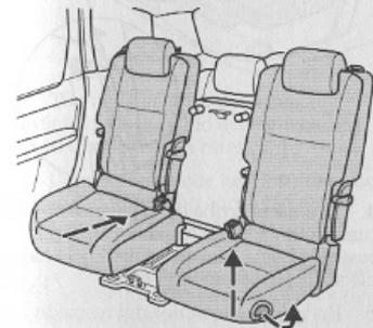
4. Tire de la palanca del borde delantero exterior de los asientos exteriores y empuje los asientos hacia atrás. Al desplazarse los asientos hacia atrás, también se desplazan ligeramente hacia adentro. Después de soltar la palanca, balancee los asientos para asegurarse de que quedan bien enclavados.
