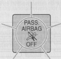
Una vez conectado el encendido (posición II), compruebe que está encendida la luz de desactivación del airbag.
