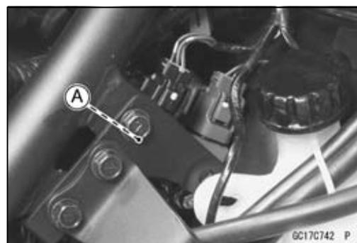
**Comprobación del voltaje de entrada del sensor del subacelerador**
