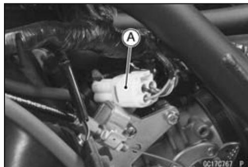
**Sensor de la válvula del subacelerador (código de servicio 62)**
