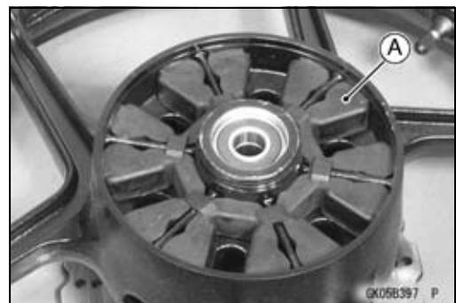
**Rueda dentada del motor, acoplamiento**
