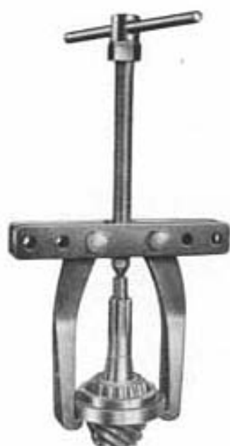
Fig. 334.—Extracción del anillo interior del rodamiento de rodillos posterior piñón cónico, por medio del extractor A. 6005 y el suplemento A. 42001.
