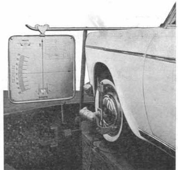
Fig. 390.—Comprobación del ángulo de inclinación de ruedas, caída o Camber.
