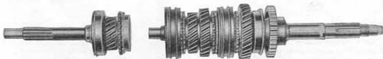
Fig. 296.—Árbol de toma constante y IV velocidad y árbol primario completo con piñones, manguitos desplazables, anillos sincronizadores y rodamientos.
