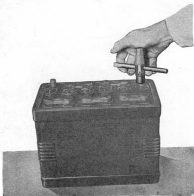
Fig. 430.—Limpieza de los bornes de cables de la batería.
