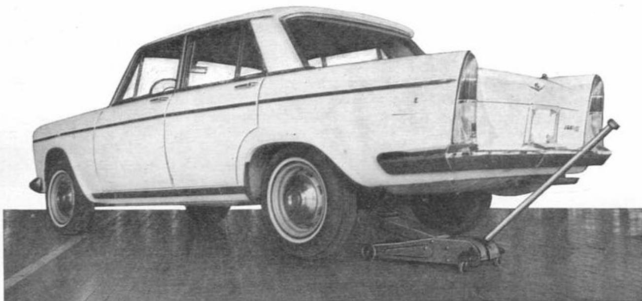
Fig. 7.—Elevación de la parte posterior del coche, mediante gato hidráulico.
