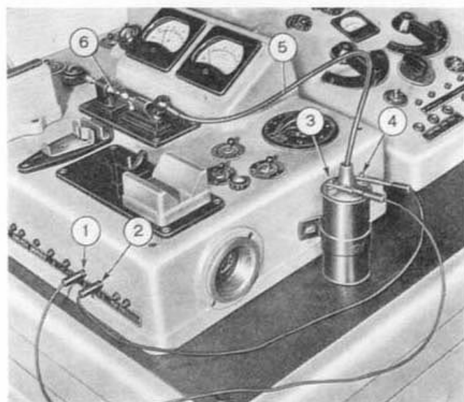
Fig. 498.—Comprobación de la bobina de encendido en el banco de pruebas.
