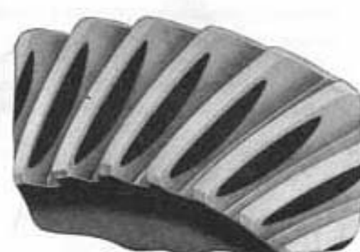
Fig. 353.—Contacto incorrecto. Lado de tiro: contacto en el talón y hacia la parte central del diente. Lado de retorno: contacto en la punta y hacia la parte central del diente. Acercar el piñón a la corona, aumentando el espesor del anillo de apoyo.
