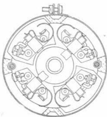
Fig. 471.—Sección sobre el soporte lado colector con vista de las escobillas.
