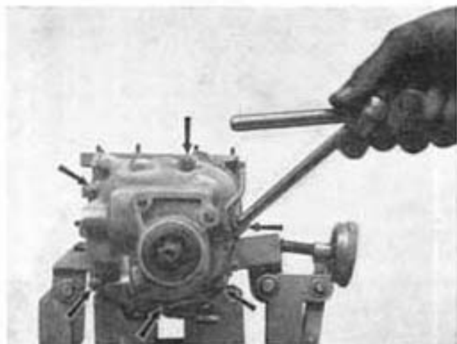
Fig. 287.—Desmontaje de la tapa posterior de la caja de cambios. Las flechas indican las tuercas de fijación de la tapa posterior al cuerpo central de la caja de cambios.
