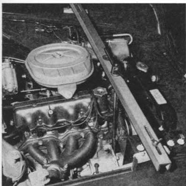
Fig. 367.—Travesaño Arr. 2062/B para sostener el motor con eje desmontado.
