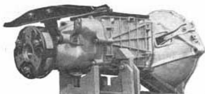
Fig. 280.—Conjunto cambio de velocidades fijado sobre el banco para revisiones Arr. 4946.
