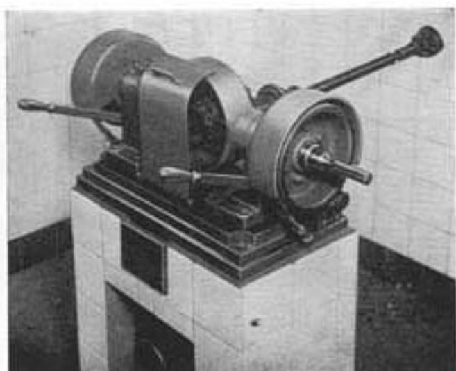
Fig. 348.—Prueba del grupo diferencial completo en el banco.
