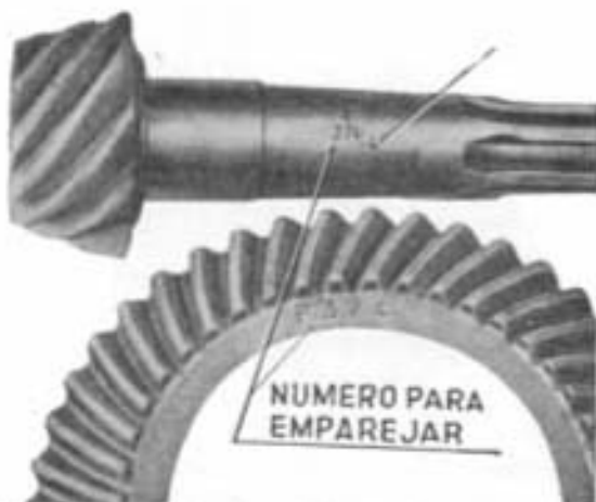
Fig. 338.—Cota centesimal sobre el piñón para determinar el espesor anillo de apoyo y cifras para emparejar.
