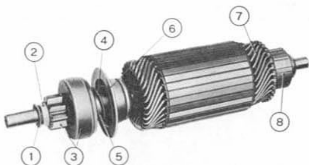
Fig. 482.—Conjunto inducido completo con dispositivo de rueda libre para acoplamiento arranque.
