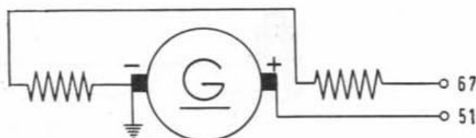
Fig. 435.—Esquema eléctrico de la dinamo DNB12-4
