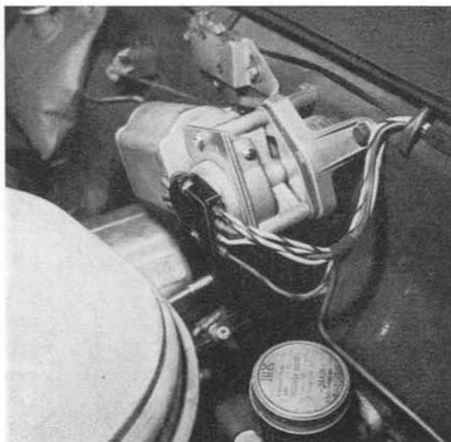
Fig. 521.—Fijación del motorreductor al salpicadero.
