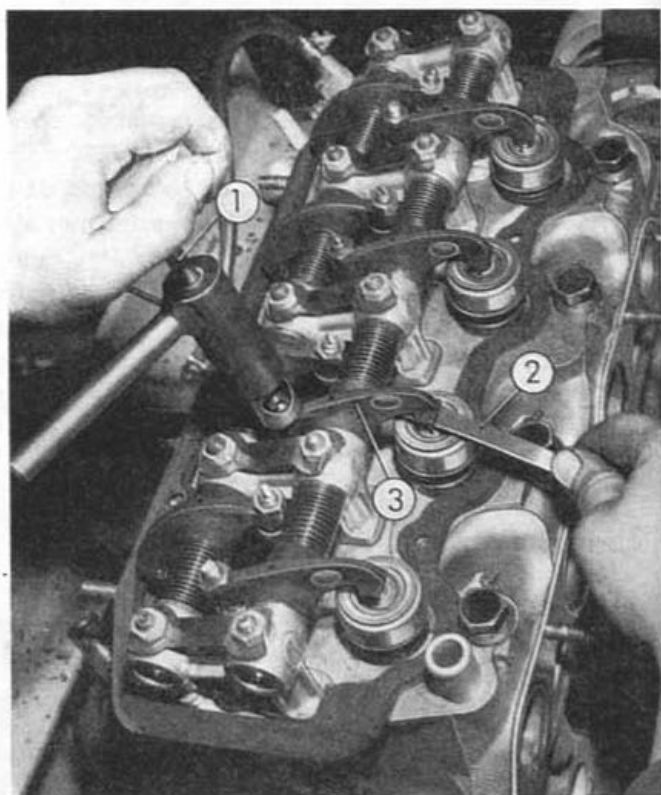
Fig. 182.—Regulación del juego entre válvulas y balancines.
