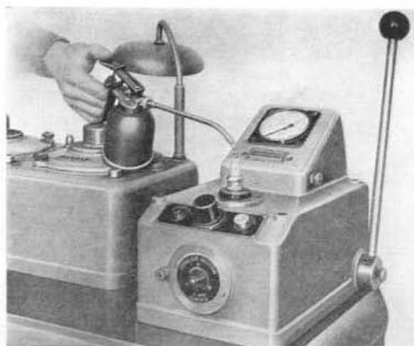
Fig. 501.—Prueba de estanqueidad de la bujía.
