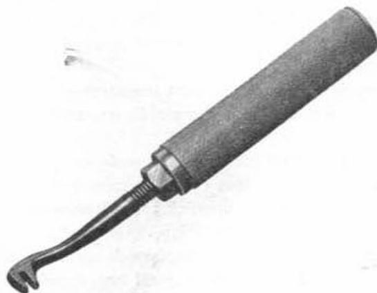
Fig. 463.—Util para modificar la posición de las lengüetas portacontactos fijos del regulador
