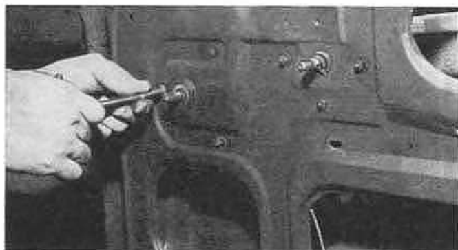
Fig. 539.—Desmontaje mando alzacrystal.
