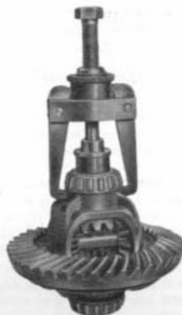
Fig. 333.—Extracción del anillo interior de los rodamientos de rodillos de la carcasa diferencial con el extractor A. 6478.
