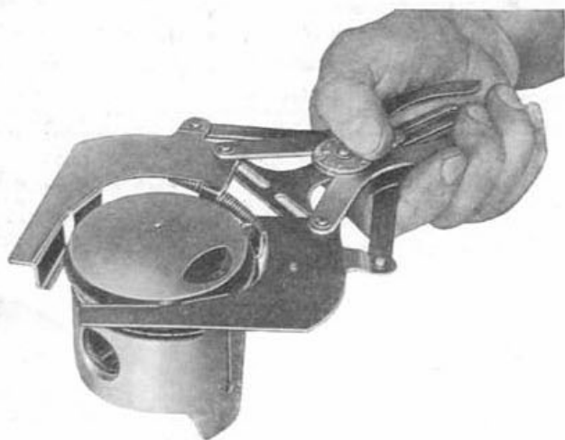
Fig. 88.—Montaje de los segmentos elásticos sobre el pistón.
