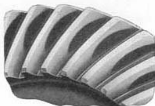
Fig. 351.—Contacto incorrecto. Lado de tiro: contacto en la punta del diente y hacia la parte central. Lado de retorno: contacto en el talón del diente y hacia la parte central. Alejar el piñón de la corona, disminuyendo el espesor del anillo de apoyo.
