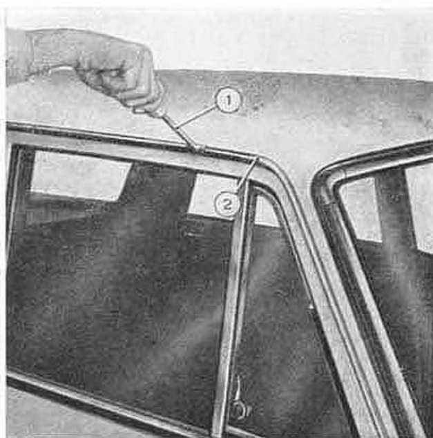
Fig. 565.—Montaje guarnición para canal vierteaguas. 1. Util.—2. Guarnición para canal vierteaguas.
