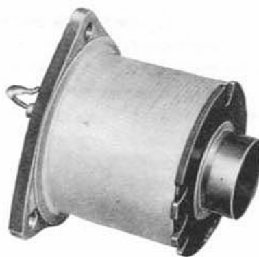
Fig. 480.—Arrollamiento contactor mando motor de arranque.
