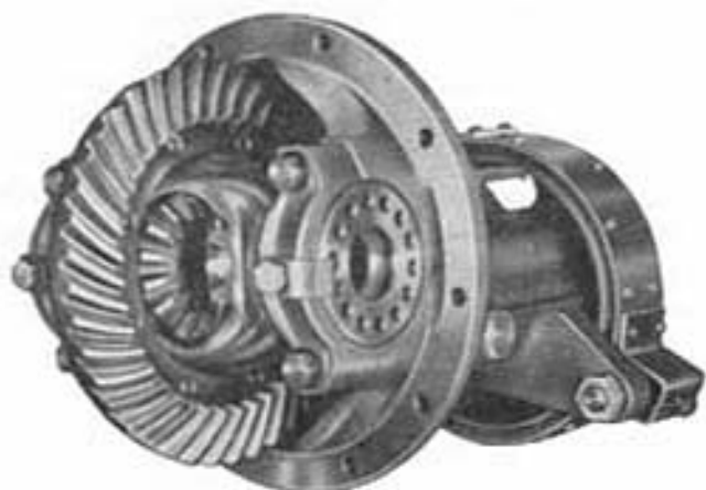
Fig. 328.—Conjunto del grupo diferencial; vista de la carcasa, satélites y planetarios.
