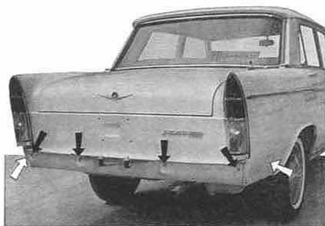
Fig. 567.—Parte posterior del coche, sin parachoques. Las flechas negras indican los espárragos para fijación central parachoques; las flechas blancas los tacos para la fijación lateral.
