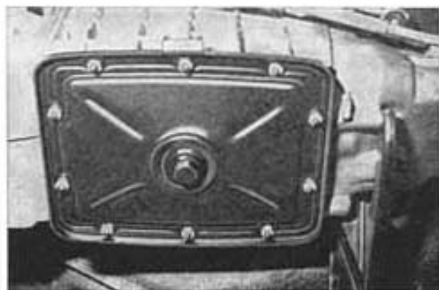
Fig. 278.—Mandos del cambio de velocidades que deben ser desconectados para separar éste del coche.
