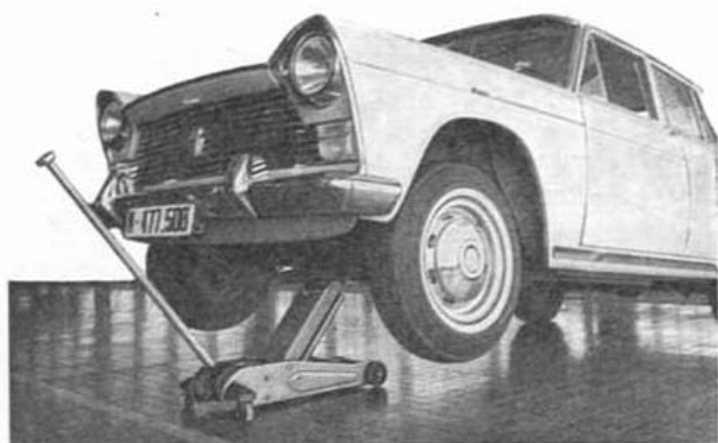
Fig. 6.—Elevación de la parte anterior del coche mediante gato hidráulico.
