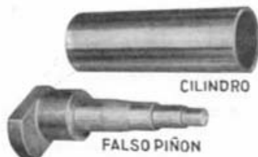
Fig. 339.—Cilindro y falso piñón para la determinación del espesor anillo de apoyo del piñón cónico.
