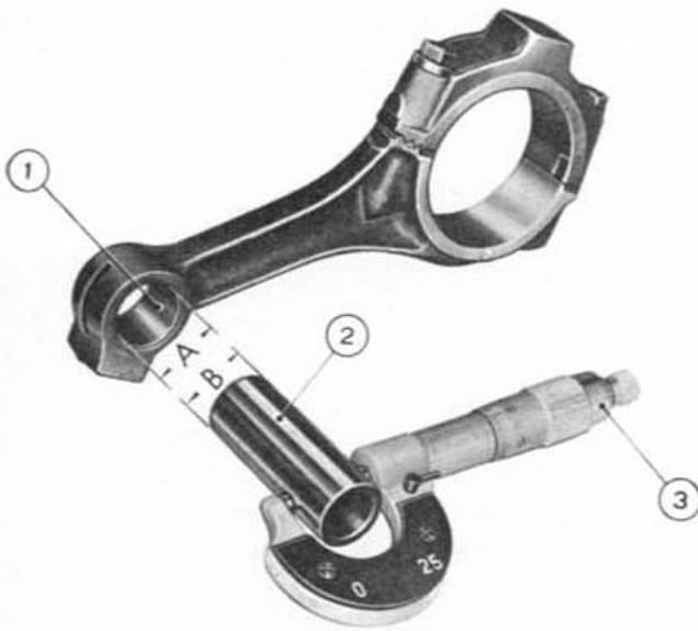
Fig. 94.—Comprobación del acoplamiento entre eje de pistón y casquillo del pie de biela.
