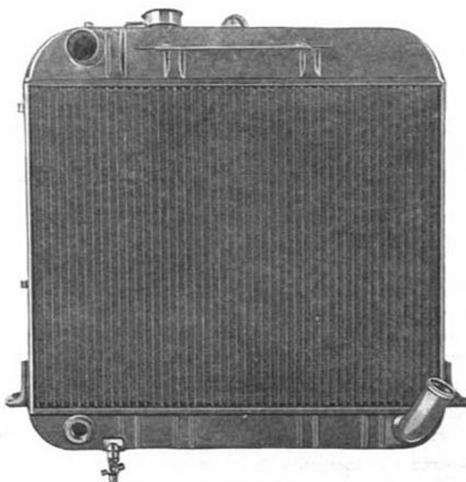
Fig. 220.—Vista posterior del radiador.
