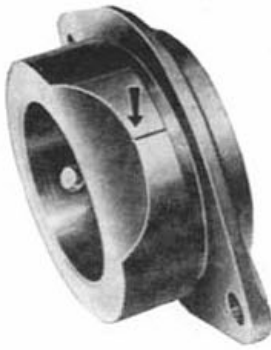
Fig. 194.—Cojinete anterior del árbol de distribución.
