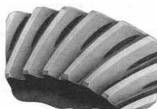
Fig. 352.—Contacto incorrecto. Lado de tiro: contacto en la punta, localizado sobre el flanco del diente, en la parte baja. Lado de retorno: contacto en el talón, localizado sobre el flanco del diente, en la parte baja. Alejar el piñón de la corona, disminuyendo el espesor del anillo de apoyo.
