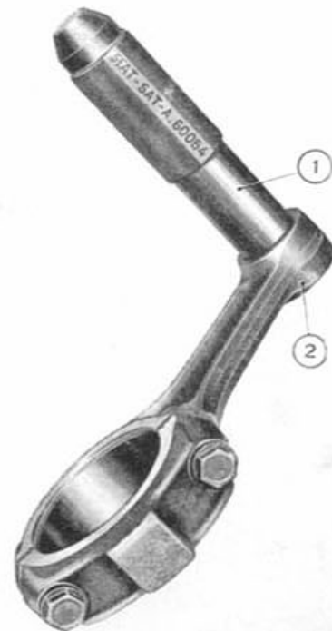
Fig. 99.—Desmontaje y montaje del casquillo del pie de biela.
