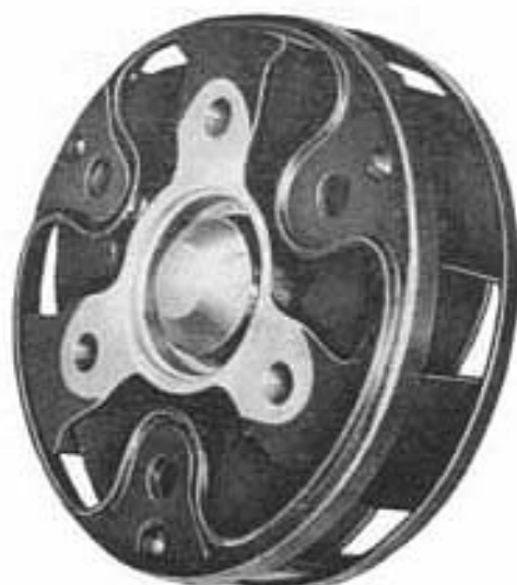
Fig. 317.—Junta flexible para unión del árbol del cambio de velocidades al árbol anterior de transmisión.
