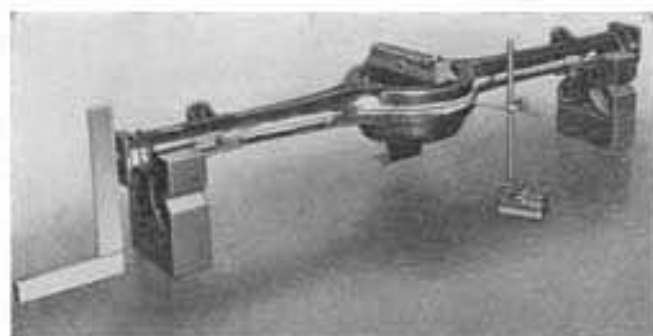
Fig. 325.—Comprobación de la alineación horizontal de la carcasa del puente.
