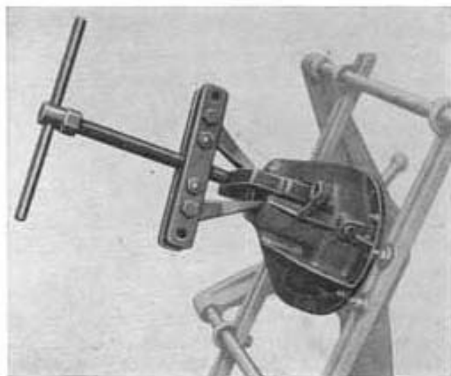
Fig. 335.—Extracción del anillo exterior del rodamiento anterior para piñón cónico, con el extractor A. 6005 y el útil A. 42002.
