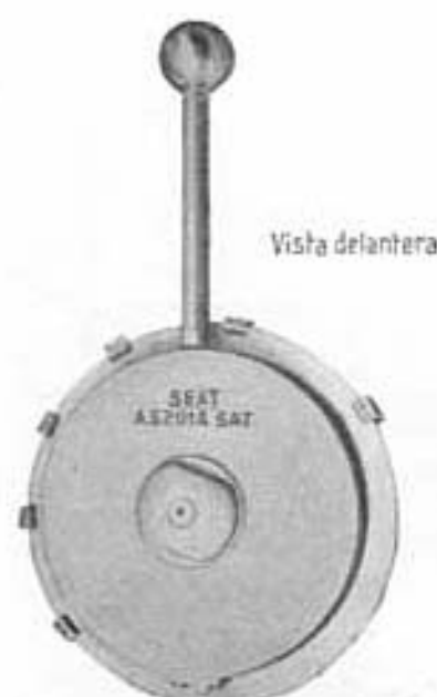
Fig. 345.—Llave dinamométrica A.52014/AB para medir el par de rotación del piñón cónico.
