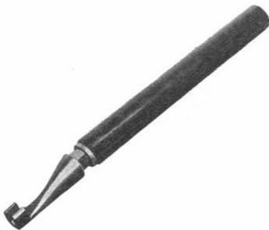
Fig. 462.—Util para modificar la posición de las lengüetas de apoyo de los resortes de lámina.
