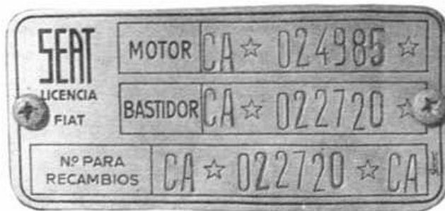
Fig. 5.—Placa con la indicación del tipo y número del chasis y del motor, colocada en la parte interior del guardabarros anterior derecho.
