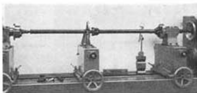
Fig. 315.—Comprobación del árbol de transmisión montado sobre contrapuntos.
