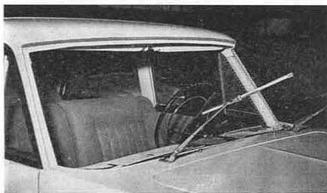
Fig. 556.—Desmontaje cristal parabrisas.
