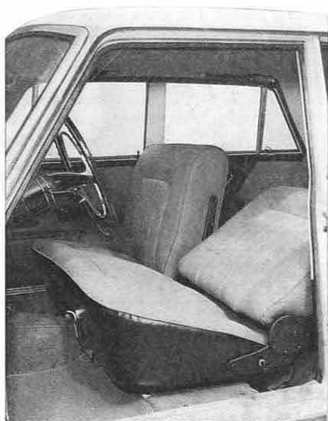
Fig. 568.—Detalle de la guarnición contorno hueco puerta.
