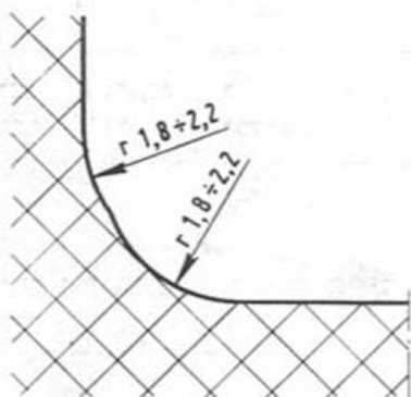
Fig. 125.—Empalmes a realizar entre muñequilla y collarín del cigüeñal en el soporte de apoyo, lado engranaje de la distribución.
