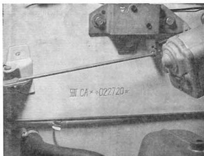
Fig. 4.—Posición del grabado del número de chasis.
