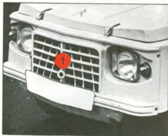
Fig. 50 - Puesta en marcha con la manivela 1 - Orificio para la manivela
