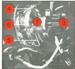
Fig. 43 - Projectores «Cruce-Carretera» 3 - Conectar 4 - 5 - Muelles de sujeción 6 - Cuello de lámparas 7 - Espárrago de posicionamiento
