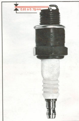
Fig. 49 - Bujías: Separación de los electrodos
