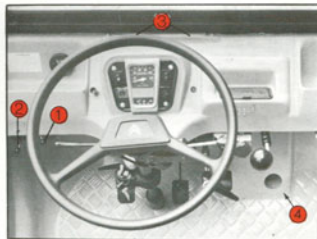
Fig. 19 - Mandos de climatización 1 - Repartición parabrisas tablero 2 - Aire caliente 3 - Tobera del parabrisas 4 - Tobera del piso
