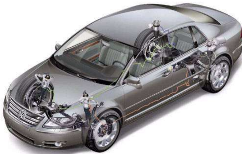
Figura 22. Elementos del sistema de suspensión neumática del VW Phaeton
