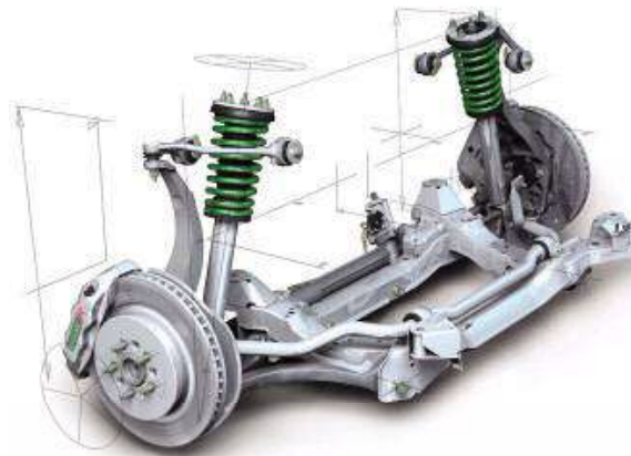
Figura 25. Tren delantero del S-Type equipado con el sistema CATS
