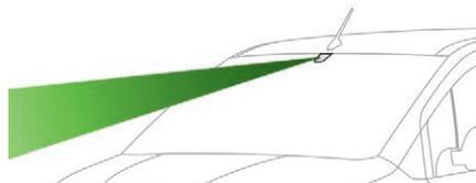
El vehículo está equipado con una cámara situada en la parte superior del parabrisas.
