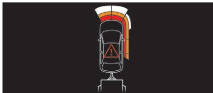
**i** La ayuda trasera al estacionamiento se desactiva automáticamente cuando si se conecta un remolque o un portabicicletas a un enganche de remolque instalado según las recomendaciones del fabricante. En ese caso, el contorno del remolque se visualiza en la parte trasera de la imagen del vehículo.
