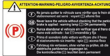
**!** Antes de salir del vehículo, confirme que el freno de estacionamiento está aplicado: los testigos del freno de estacionamiento en el cuadro de instrumentos y del mando deben estar encendidos de manera fija (sin parpadear).
