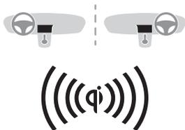
Permite recargar sin cables un dispositivo portátil, como un smartphone, utilizando el principio de inducción magnética, según la norma Qi 1.1.
