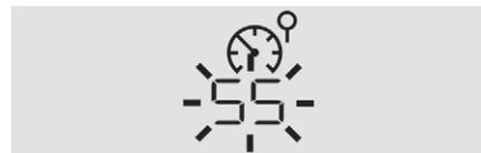
El limitador se desactiva momentáneamente y la velocidad de cruceo indicada parpadea. Si se excede durante un tiempo prolongado, termina por activarse un aviso sonoro. Basta con soltar el pedal del acelerador para volver a la velocidad de cruceo.
