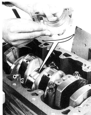
Montaje del apoyo central con semicojinete (incorporando los separadores de reglaje del juego axial).
