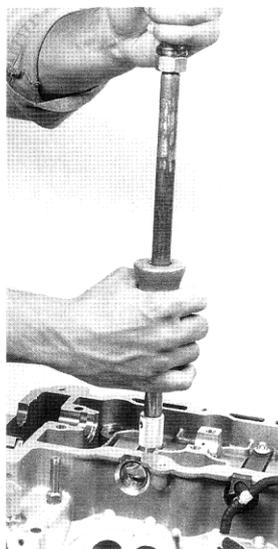
Desmontaje de un inyector con ayuda de un extractor de inercia y del adaptador KM-931.
