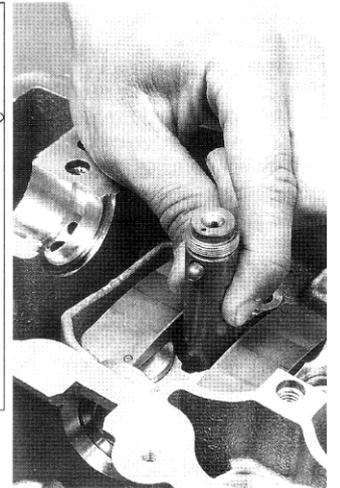
Montaje de un inyector : orientación de la bola de posicionado.
