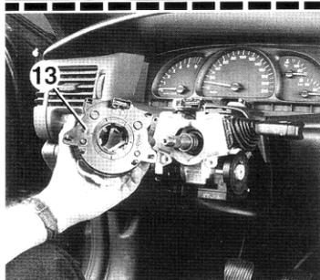
Alineamiento de las marcas del contactor de airbag.
