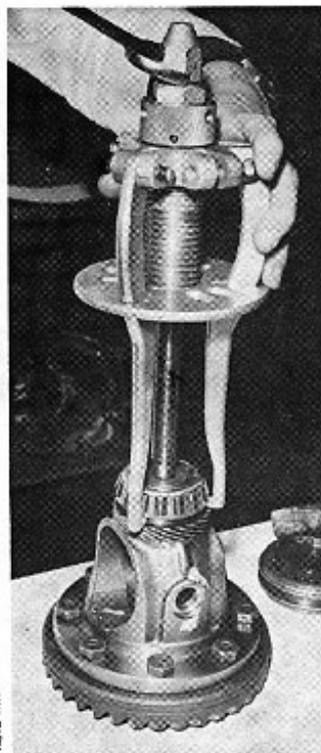
Dépose des roulements de différentiel
