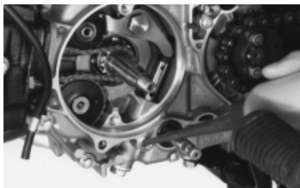
Verifique se a arruela de vedação está em bom estado e instale-a juntamente com o parafuso de vedação.
