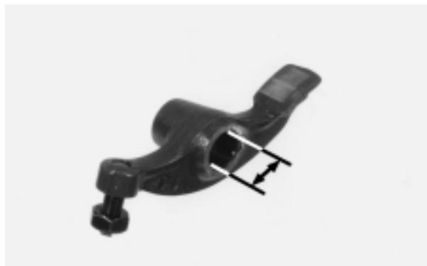
**INSPEÇÃO DOS EIXOS DOS BALANCINS**
