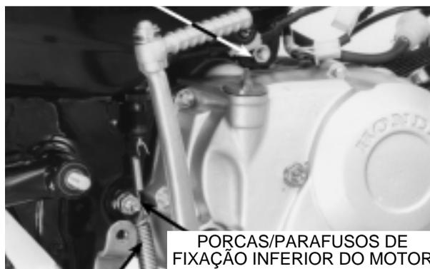
PORCAS/PARAFUSOS DE FIXAÇÃO INFERIOR DO MOTOR
