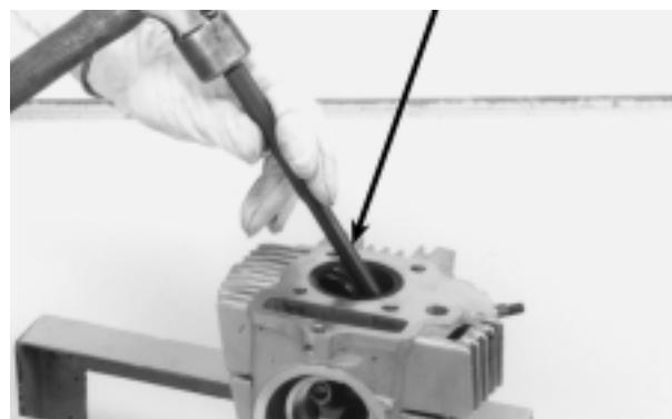
Lubrifique os anéis de vedação novos com óleo limpo de motor e instale-os nas guias novas.
