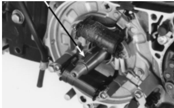
Limpe a parte interna do rotor e instale-o alinhando a ranhura com a chaveta da árvore de manivelas.
