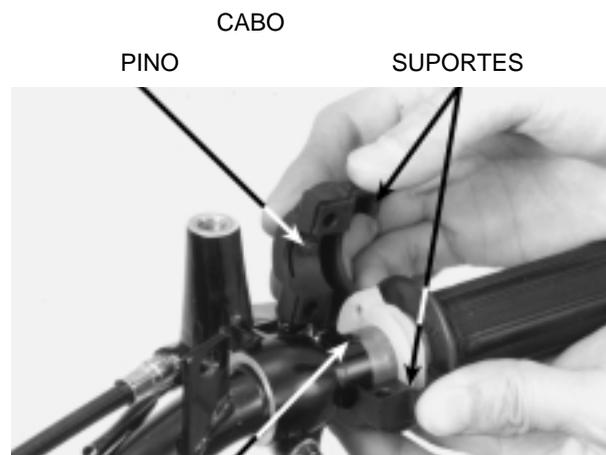
Limpe toda superfície interna da manopla esquerda e a superfície de contato do guidão.
