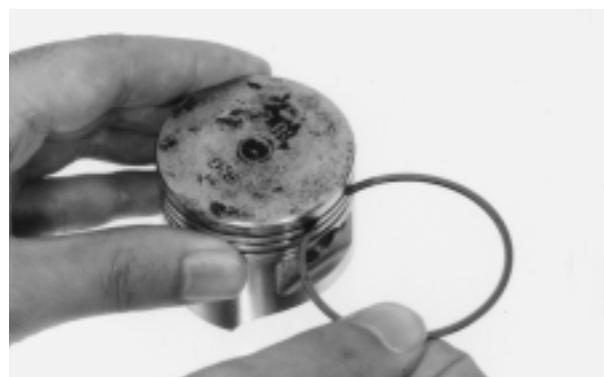
Instale temporariamente os anéis em suas respectivas canaletas, com as marcas gravadas voltadas para cima.
