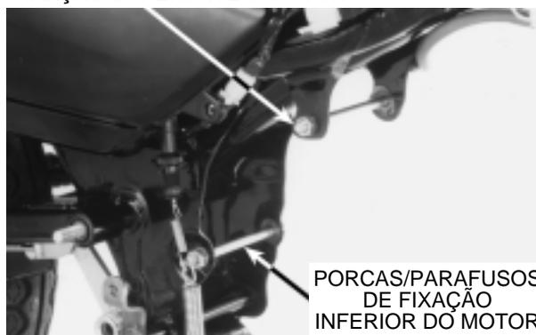
PORCAS/PARAFUSOS DE FIXAÇÃO INFERIOR DO MOTOR
