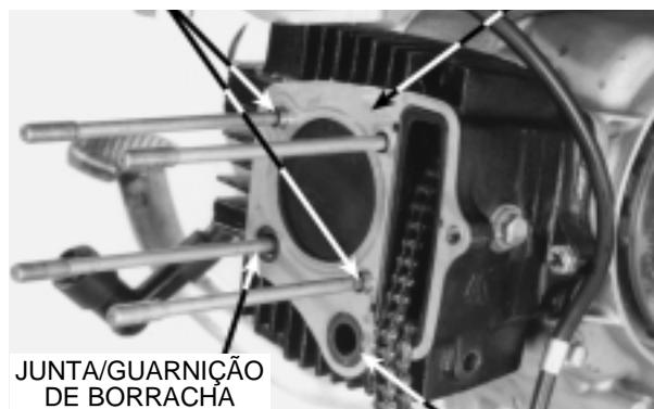
JUNTA/GUARNIÇÃO DE BORRACHA
