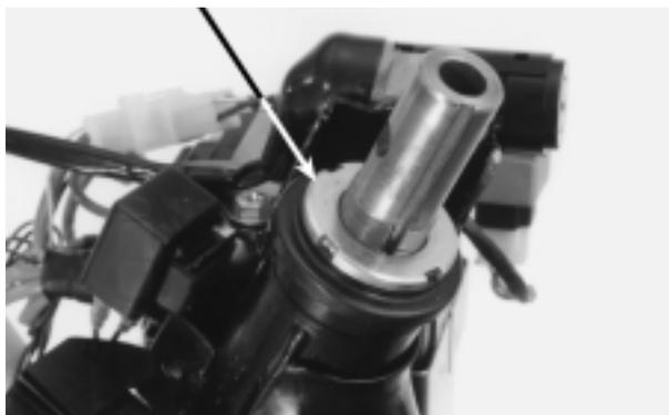
2. Gire a coluna de direção completamente para a direita e para a esquerda no mínimo cinco vezes para assentar os rolamentos.
