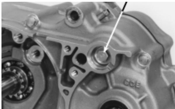
Instale a tampa de borracha, tubo de respiro do motor e a corrente de comando.
