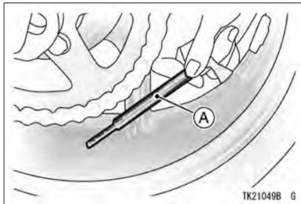
**A.** Medidor de presión de los neumáticos
