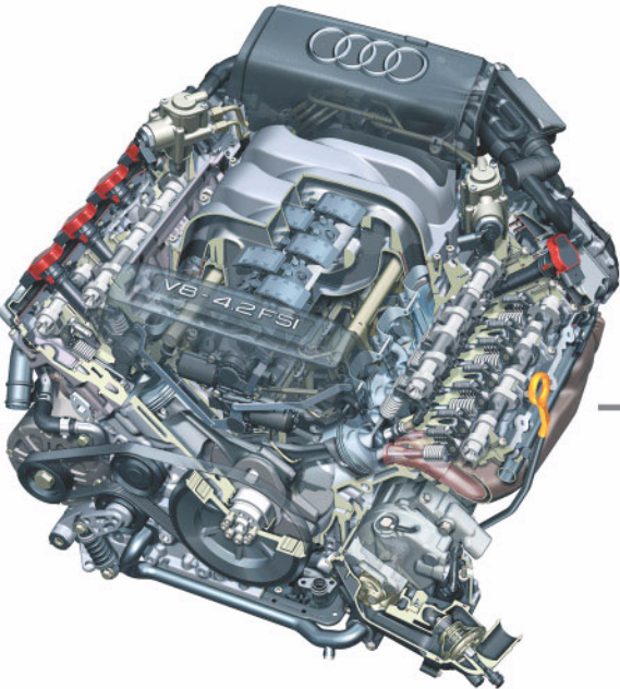
4,2l V8 - Motor de inyección de gasolina FSI
