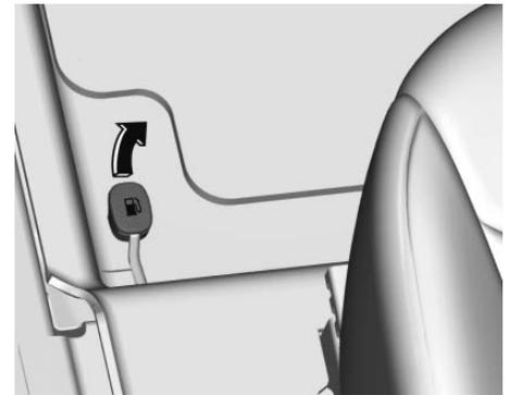
Para abrir la puerta de llenado de combustible, levante la palanca de liberación de la puerta de combustible. La palanca está en el suelo, en la parte delantera izquierda del asiento del conductor.
