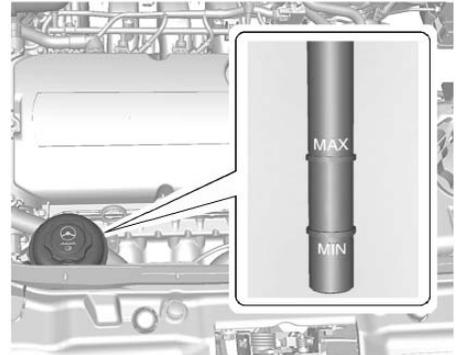
Cuando el motor está caliente, el nivel debe estar en el nivel MAX caliente. Cuando el motor está frío, el nivel del líquido debe estar entre las marcas MIN y MAX de la varilla de medición.
