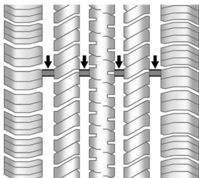
Los indicadores de desgaste del dibujo son una de las maneras de decidir cuándo es el momento para nuevas llantas. Los indicadores de desgaste aparecen cuando las llantas tienen solamente 1.6 mm (1/16 de pulgada) de dibujo remanente. Vea *Inspección de las llantas* ⇨ 217 y *Rotación de la llanta* ⇨ 217.
