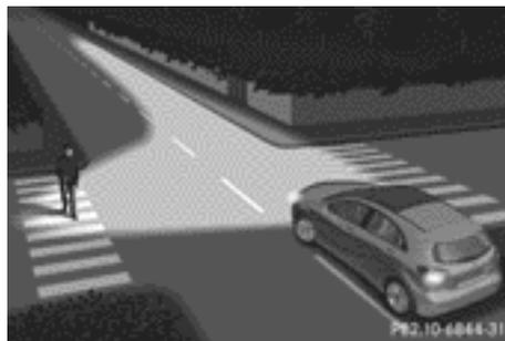
La luz de desvío mejora la iluminación de la calzada en la dirección del desvío, de manera que, por ejemplo, las curvas cerradas sean más visibles. Solo puede activar la luz de desvío si la luz de cruce está conectada.
