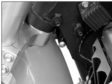
Per l'inserimento del bloccasterzo occorre sterzare il manubrio completamente a destra, introdurre la chiave, premere e ruotare completamente la chiave in senso antiorario e dopo rilasciarla.
