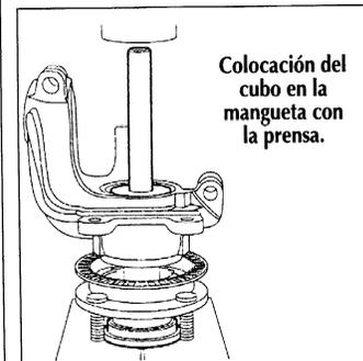
Colocación del cubo en la mangueta con la prensa.
