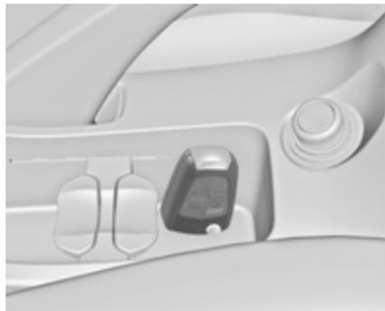
Abra la tapa en la parte inferior del portavasos de la consola central. Extienda la llave electrónica e introdúzcala en la cerradura.
