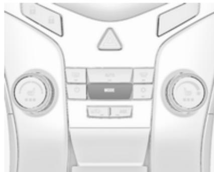
Pulse el botón **MODE** una vez, o repetidamente, para efectuar el ajuste deseado; el ajuste de la distribución de aire se indica en la pantalla de información.
