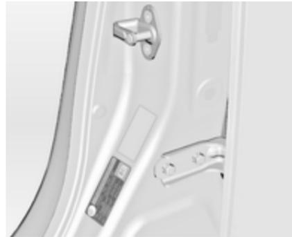
Presión de los neumáticos ⇨ 338 y en la etiqueta colocada en el marco de la puerta delantera izquierda.
