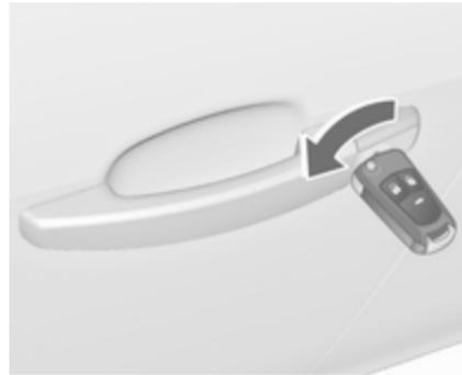
Desbloquee manualmente la puerta del conductor girando la llave en la cerradura. Conecte el encendido y pulse el botón del cierre centralizado
