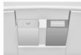
Debajo de la cubierta de la consola central hay un puerto USB para conectar fuentes de audio externas.
