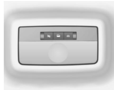
Al entrar y salir del vehículo, se encienden automáticamente las luces de cortesía, luego se apagan con un leve retardo. Se enciende brevemente aunque la llave se saque de la cerradura del encendido.
