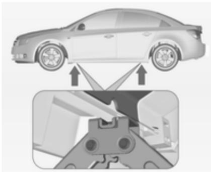
4. Asegúrese de que el gato esté correctamente colocado en los puntos de elevación del vehículo.
