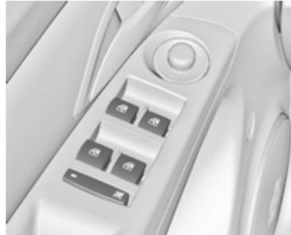
Pulse el interruptor
