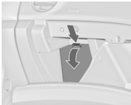
En los vehículos con volante a la derecha, la caja de fusibles está situada detrás de una tapa en la guantera. Abra la guantera y desmonte la tapa.
