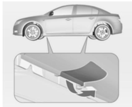
Coloque la mano detrás de la cubierta del revestimiento del estribo.
