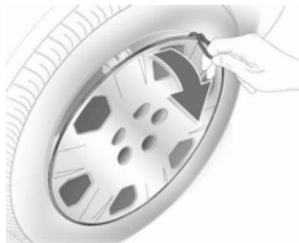
1. Desenclave los tapones de las tuercas de rueda con un destornillador y desmóntelos. Quite el tapacubos con el gancho. Herramientas del vehículo ⇨ 287.
