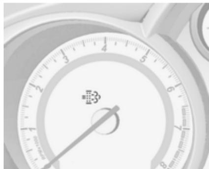
El testigo de control
