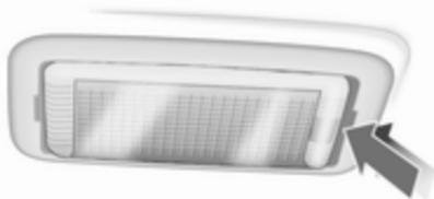
1. Extraiga la lámpara haciendo palanca con un destornillador.
