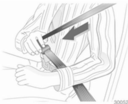
Extraiga el cinturón del retractor, guíelo por encima del cuerpo sin retorcerlo e inserte la lengüeta en el cierre. Durante el viaje, tense frecuentemente el cinturón abdominal ti-
