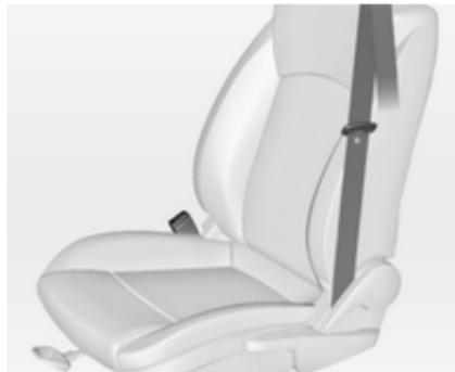
En caso de colisiones frontales y laterales, a partir de una determinada gravedad, se tensan los cinturones de seguridad delanteros.
