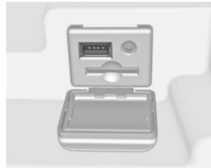
Debajo de la cubierta de la consola central hay un puerto USB para conectar fuentes de audio externas.
