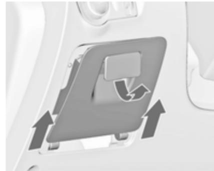
La caja de fusibles está detrás del compartimento portaobjetos en el tablero de instrumentos.
