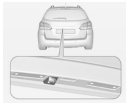
**Station Wagon:** La cámara está montada debajo de la moldura del portón trasero.
