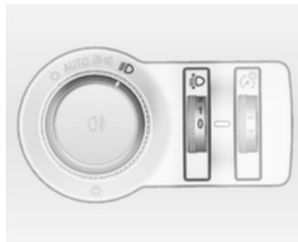
Para adaptar el alcance de los faros a la carga del vehículo y evitar el deslumbramiento: gire la rueda de ajuste
