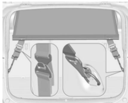
Fije el gancho inferior con la abertura mirando hacia atrás respecto a la argolla de la pared lateral derecha e izquierda, respectivamente. Ajuste la longitud de las correas de la red de seguridad fijando el gancho superior a las argollas de la correa. Mantenga la correa tensada mientras instala la barra.
