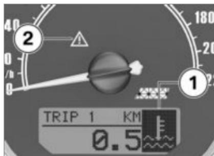
Los avisos para los que no se dispone de un testigo de aviso independiente, se representan mediante un símbolo de advertencia **1** en la pantalla multifunción, en combinación con el testigo de aviso general **2**. En función de la urgencia de la advertencia, el testigo de aviso general se enciende fijo o parpadea.
