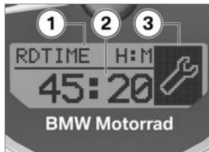
Si el tiempo de conducción dura más de una hora, la unidad **1** cambia de **M:S** a **H:M**. En el valor **2** se visualizan en lo sucesivo horas y minutos.
