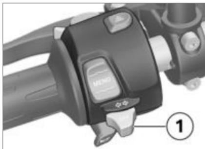
Si se ha pulsado la tecla **1** un rato más hacia la derecha o la izquierda, los intermitentes solo se apagan automáticamente una vez que se ha alcanzado el recorrido dependiente de la velocidad.
