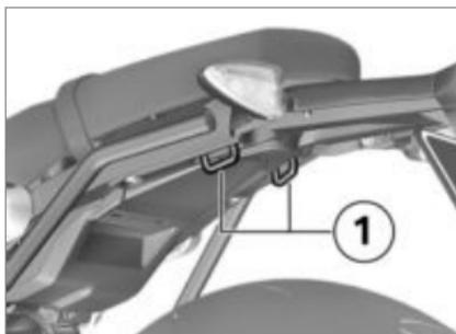
Sujetar el equipaje (p. ej. la bolsa trasera) con las argollas de amarre **1**.
