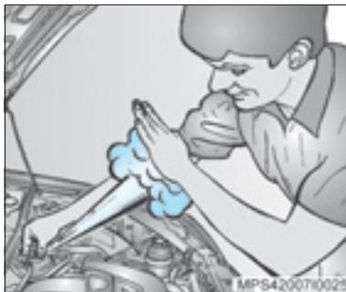
**⚠ Peligro** Los vapores y líquidos hirvientes provenientes del sistema de líquido de enfriamiento en ebullición están bajo alta presión, y si la tapa del depósito fuese abierta aunque parcialmente, los vapores podrían ser expelidos en alta velocidad, o también explotar, llevando a quemaduras graves. Jamás gire la tapa del depósito mientras el motor y el sistema de enfriamiento estuviesen calientes. Si fuese necesario girar la tapa, espere hasta que el motor enfríe.
