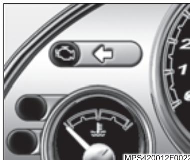
Cuando el encendido fuese conectado, el indicador de control del sistema de inyección electrónica
