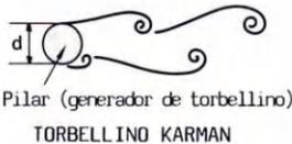
Utilizando este principio, se mide la frecuencia de los torbellinos generados mediante el generador de torbellinos, haciendo posible determinar el volumen del flujo de aire.
