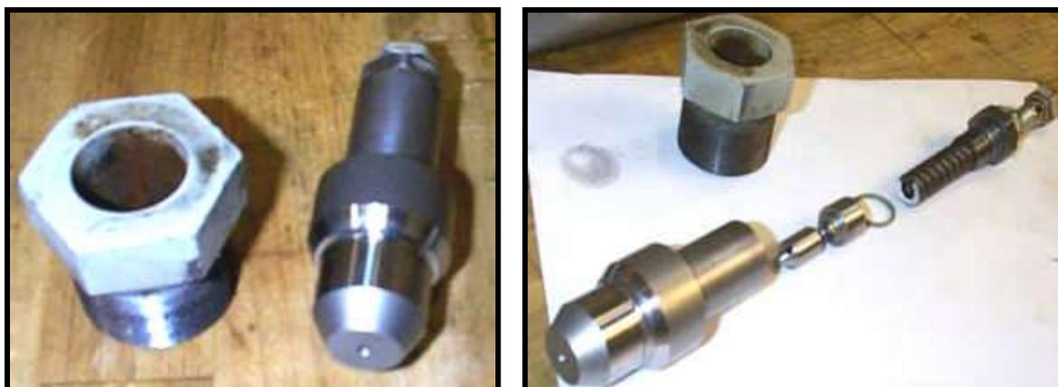
Válvula de Seguridad del Riel de Alta Presión
