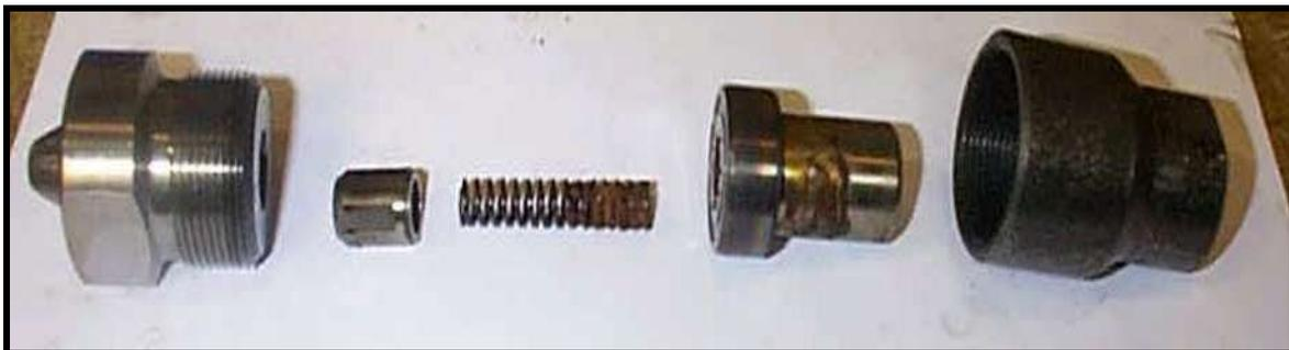
Fig. \_\_\_ DESARME DE LA VÁLVULA LIMITADORA DE FLUJO
