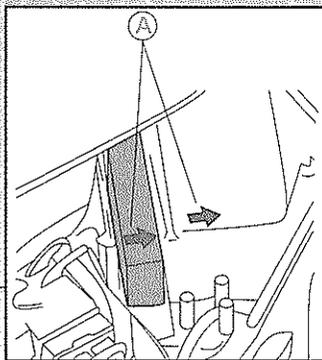
Remettre en place le filtre à particules en procédant de la même manière que pour la dépose.
