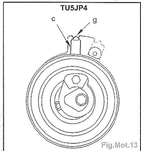
Attention : L'index (c) ne doit pas dépasser l'encoche «g». Dans le cas contraire, reprendre l'opération de tension de la courroie de distribution.
