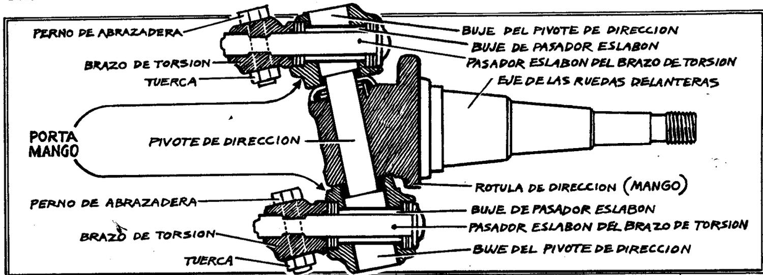
El pasador atraviesa el porta mango con los calzos de ajuste en cada lado de él, y luego atraviesa la abrazadera del brazo de torsión. El perno que atraviesa la abrazadera no solamente aprieta el pasador, pero también funciona como un punto de ajuste. Hay una ranura espiral como una huella de gusano forjado dentro del pasador, entonces cuando das vuelta al pasador usando la extremidad plana, el pasador se mueve o adentro o afuera según como le des vuelta.
