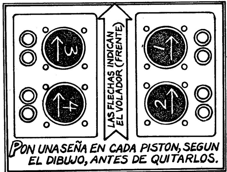
Con un clavo o una lima, rasca el número en la parte superior del pistón, a través del carbón y dibuja una flecha indicando la posición del volador como en el dibujo. Empieza con el No. 1, voltea el motor hasta que el No. 1 salga lo más que pueda, y acuérdate del AVISO.
