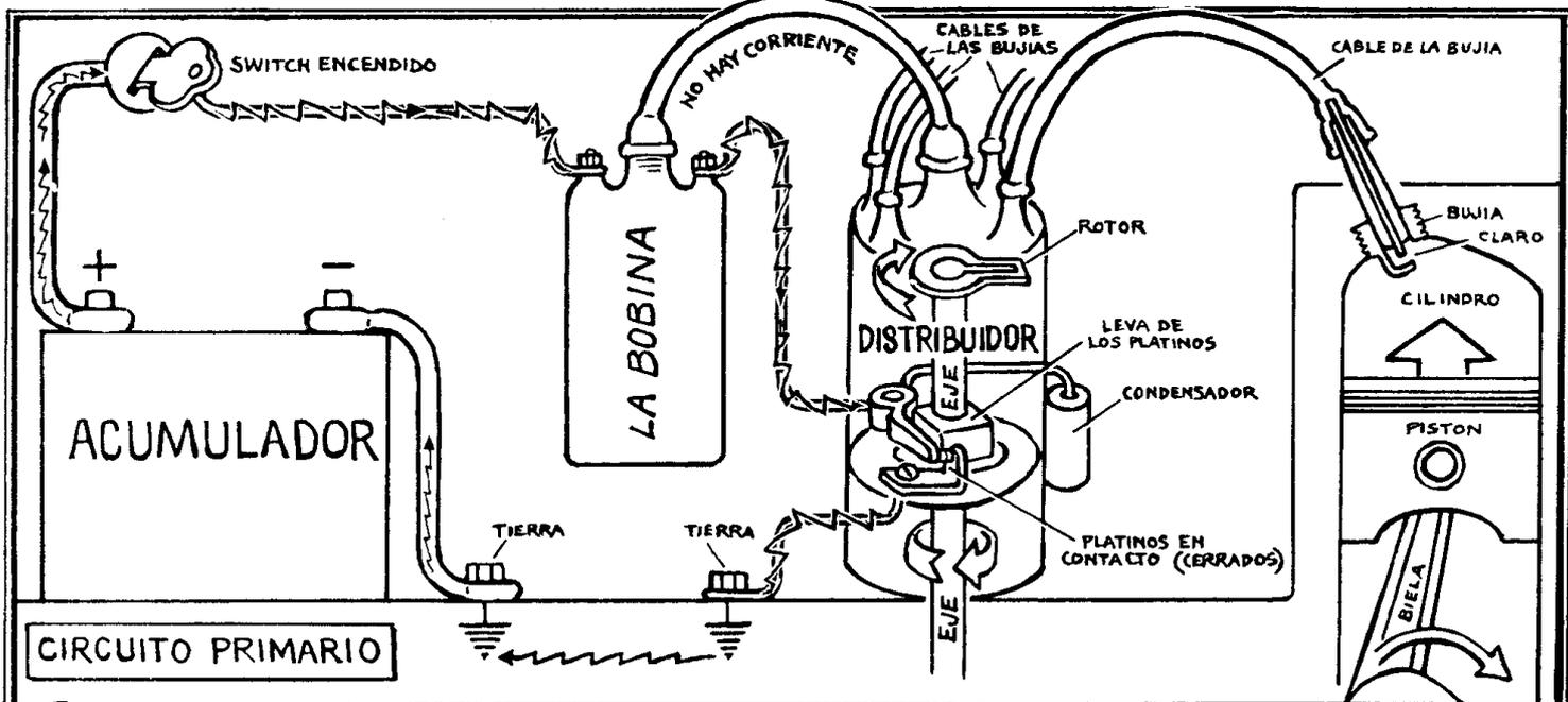
CUANDO LOS PLATINOS ESTAN ABIERTOS, EL CONDENSADOR TOMA LA CORRIENTE Y ASI SE ROMPE EL CIRCUITO PRIMARIO. EN ESTE MOMENTO LA BOBINA PRODUCE LA CORRIENTE DE ALTO VOLTAJE QUE VA AL DISTRIBUIDOR Y ENSEGUIDA A LA BUJIA.
