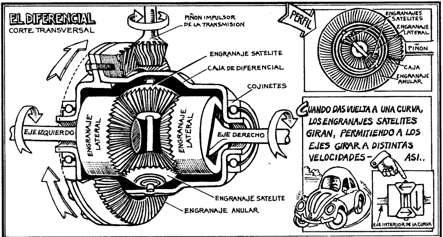
El diferencial también cambia la dirección de la torsión del giro del motor al giro de las ruedas. Para esto se utiliza el engranaje de anillo del piñon de impulso como se ve en el dibujo. En realidad, en el Volkswagen los ejes de mando se mueven de arriba abajo según el camino y tienen uniones de velocidad constante en cada lado.
