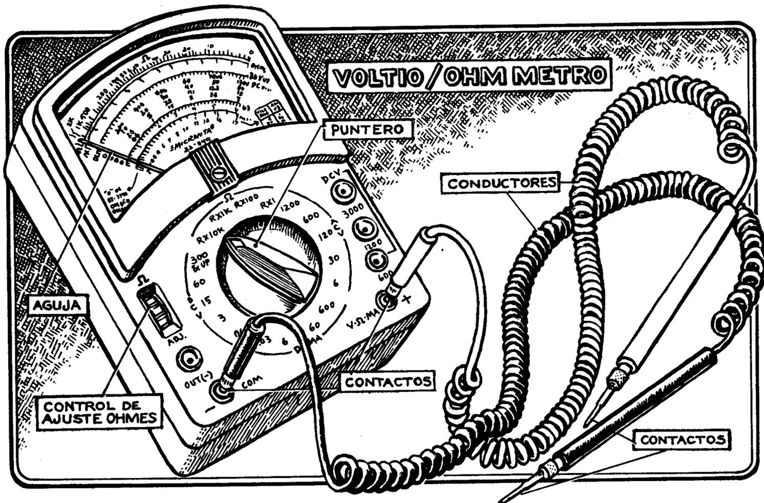
El que tienes tal vez se ve diferente y tiene el nombre o los símbolos diferentes para las varias escalas pero todos miden el mismo fenómeno eléctrico: voltios (ambas corrientes, CA - corriente alterna y CC - corriente continua), resistencia (en Ohms, ohmios) y amperios (amps). El voltaje es algo como la presión del agua (la fuerza con que pasa la electricidad por "la manguera") y la resistencia es como fricción (rosando contra el lado de la manguera). Hay continuidad cuando no hay resistencia.
