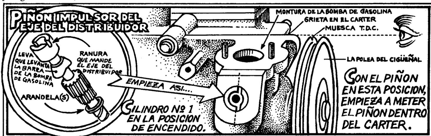
Usa el desarmador para detener la ranura en la posición correcta, mientras empujas el piñon impulsor hasta el fondo del agujero y hasta que se ajuste sobre el anillo o los anillos. Da vuelta al motor un poquito para ver si el engranaje se ajustó; si la ranura gira cuando das vuelta al motor, el piñon está ajustado.
