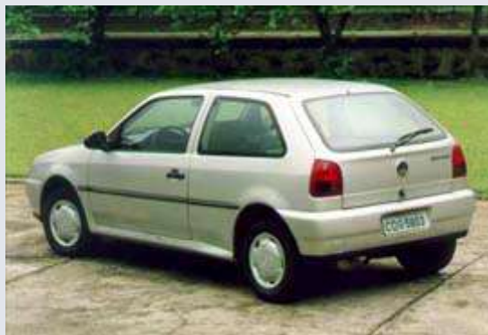
Una nueva generación en 1994: mayor distancia entre ejes, buen espacio interno, aerodinámica eficiente. Los motores y suspensiones, de robustez comprobada, eran mantenidos.
