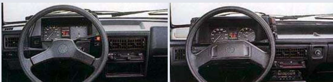
En cuanto a versiones más simples, traían un nuevo panel de instrumentos cuadrado (a la izquierda), y para las versiones más completas, instrumentos con cuadros circulares y teclas cercanas al volante derecha).
