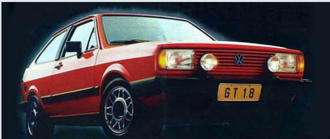
Primer Gol "a agua", el GT venía con butacas Recaro, neumáticos 185/60-R14 y un motor 1.8 que saldría del Santana, con leva y carburador más "raviosos".
