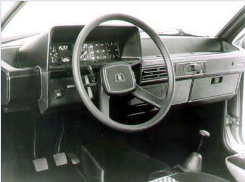
El interior traía elementos modernos como cinturones de tres puntos, opcionales. El panel recordaba al del Passat, pero con instrumentos pequeños y rectangulares del Variant II.
