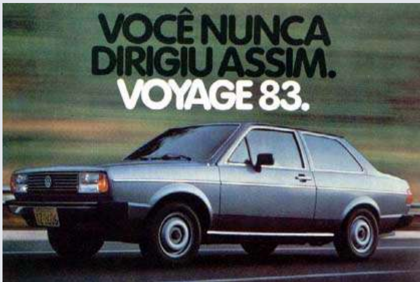
Con el Voyage, dos novedades: un nuevo volumen para el baúl y el motor 1.5 litros refrigerado a agua del Passat, substituido por un 1.6 litros a partir de 1983.
