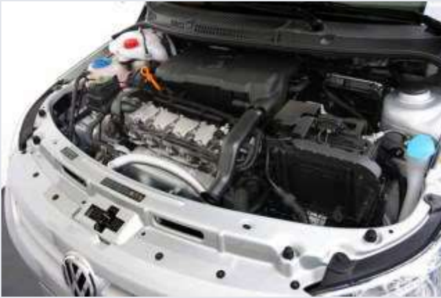
Motor del G5, a diferencia de sus antecesores, la disposición del mismo es transversal.
