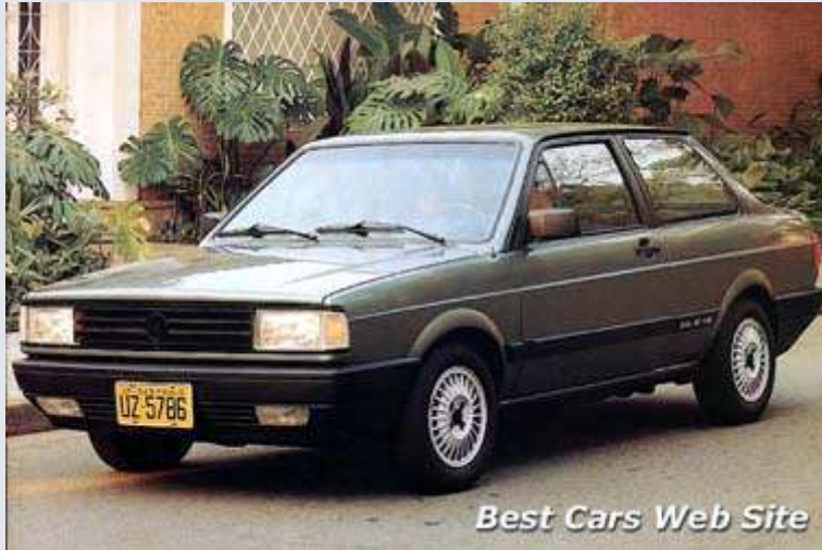
El primer reestiling de la familia trajo un capot más bajo y parachoques embolventes, acompañados por nuevos paneles y retrovisores (como en este Voyage GLS) en 1988.
