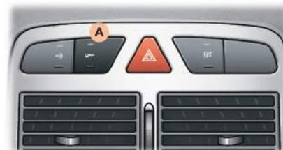
El impulso en el botón **A** le permite bloquear o desbloquear el vehículo. El testigo rojo del botón se enciende en el bloqueo y se apaga en el desbloqueo.
