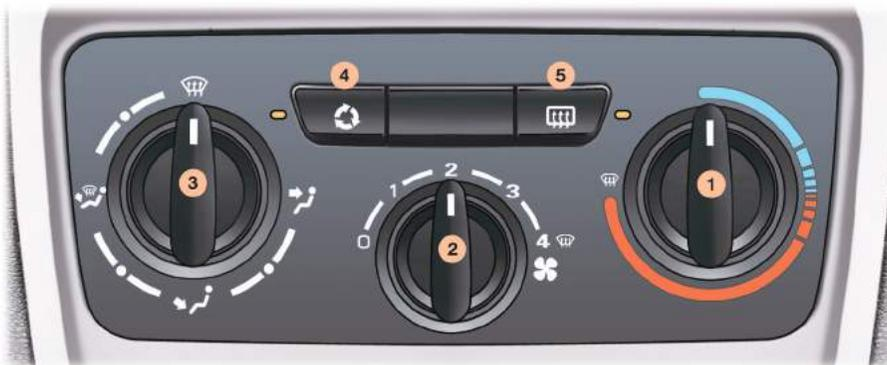
La calefacción y la ventilación sólo pueden funcionar motor en marcha.
