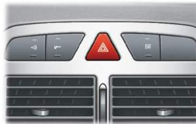
Pulse en el botón, los indicadores de dirección (intermitentes) parpadean. Puede funcionar con el contacto quitado.
