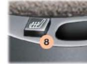
Motor en marcha, pulse el interruptor. La temperatura se regula automáticamente.
