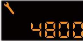
5 segundos después de poner el contacto, el totalizador kilométrico vuelve a su funcionamiento normal y la pantalla indica el kilometraje total y parcial.
