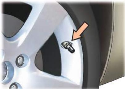
Unos sensores, montados en cada válvula, controlan la presión de los neumáticos al circular y disparan una alerta en caso de disfuncionamiento (velocidad superior a 20 km/h).
