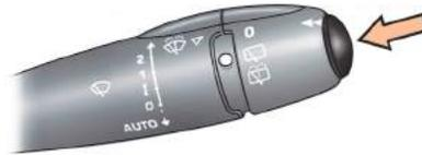
Pulse en el botón, situado en el extremo del **mando del limpia-parabrisas**, para señalar sucesivamente los diferentes datos del ordenador de a bordo :
