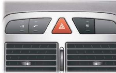
En condiciones excepcionales (arranque del vehículo enfangado, inmovilizado en la nieve, sobre terreno blando...), puede ser útil neutralizar los sistemas ASR y ESP para que las ruedas patinen y tener así mayor adherencia.
