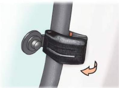
Para entreabrir las lunas traseras, bascule la palanca, y empújela a fondo para bloquear las lunas en posición abierto.
