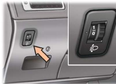
Para los vehículos equipados con lámparas halógenas, en función de la carga de su vehículo, se recomienda corregir su reglaje.
