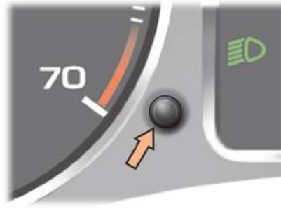
Luces encendidas, pulse el botón para variar la intensidad de la iluminación del puesto de conducción. Cuando la iluminación alcanza el reglaje mínimo (o máximo), suelte el botón y vuelva nuevamente a pulsarlo para aumentar la intensidad (o disminuirla).
