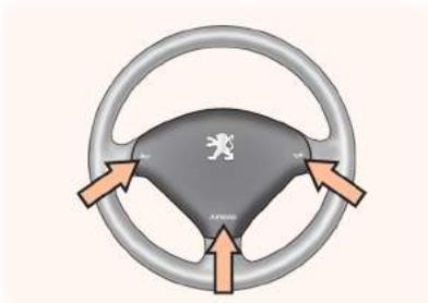
Pulse en uno de los radios del volante.
