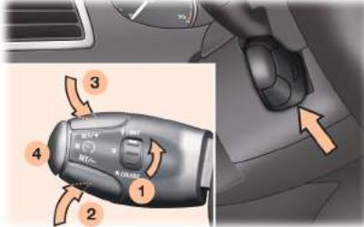
Este limitador de velocidad, nueva generación, tiene una pantalla en el combinado para visualizar la velocidad programada.
