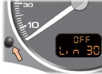
Función limitador de velocidad activada, un impulso en este botón permite señalar los totalizadores kilométricos. Después de unos segundos o con un nuevo impulso en este botón, la señalización vuelve a la función limitador de velocidad.
