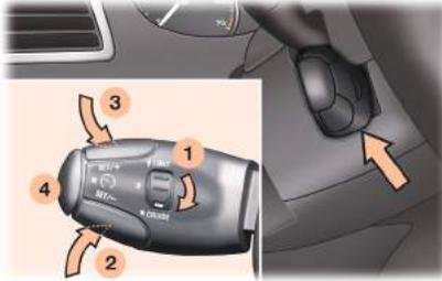
Este regulador de velocidad, nueva generación, está acoplado al limitador de velocidad. Tiene una pantalla en el combinado para visualizar la velocidad de consigna memorizada.
