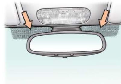
El parabrisas atérmico tiene dos zonas no reflectantes situadas a cada lado de la base del retrovisor interior.
