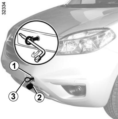
Utilice exclusivamente el punto de remolcado delantero 1 y el punto de remolcado trasero 4 (nunca los árboles de transmisión). Estos puntos de remolcado tan sólo se pueden emplear para remolcar, en ningún caso deben servir para levantar directa o indirectamente el vehículo.
